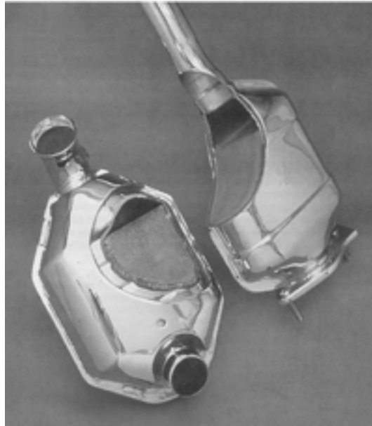
شکل ۳-۳۰- تصویر برش خورده یک مبدل کاتالیستی
