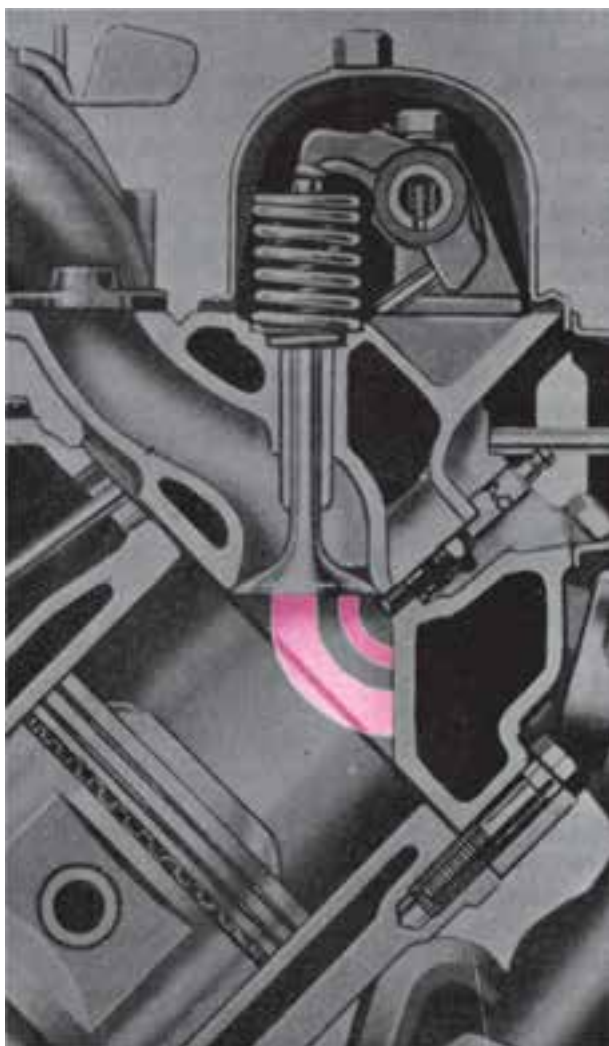
شکل ۱۲-۳- نمایش احتراق عادی که از طرف شمع شروع می‌شود.
