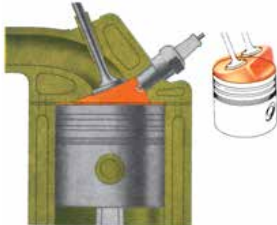
شکل ۱۴-۳- در این اتاق احتراق (گوه‌ای شکل)، شعله بهتر پیشروی می‌کند.
