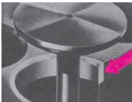
شکل ۱۹-۲- سیت سوپاپ اغلب از مواد سخت ساخته می‌شود و به طور پرسی نصب می‌گردد.
