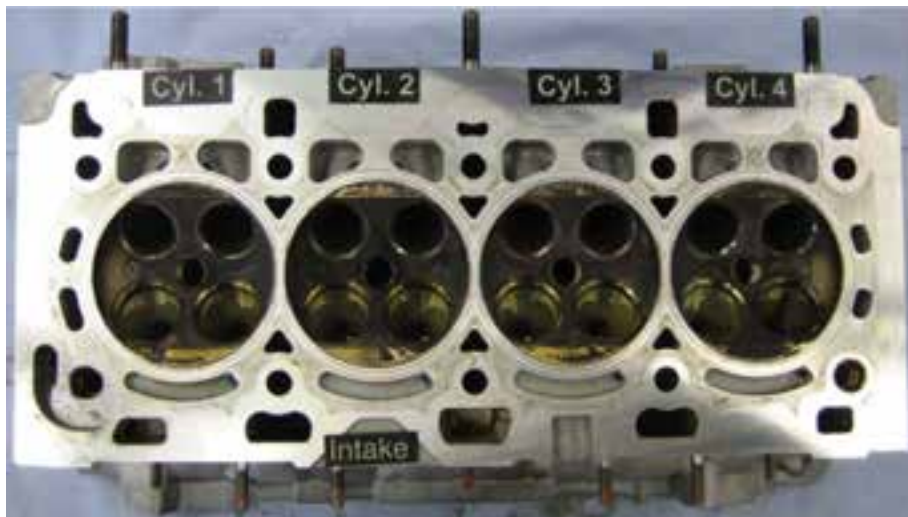
شکل ۳-۲- بدنه اصلی سرسیلندر یک موتور ۱۶ سوپاپ
