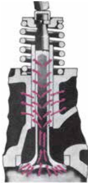
شکل ۲۹-۲- انتقال حرارت گرمای سر سوپاپ به گیت و آب خنک کاری
