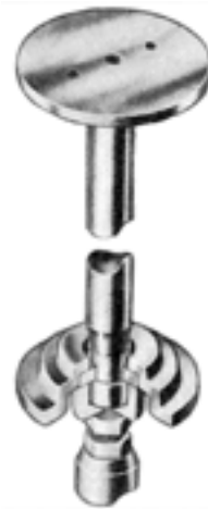
شکل ۲۵-۲- ساختمان سوپاپ گردش آزاد
