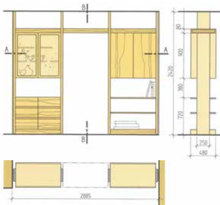
شکل (۴-۲۰) ترسیم نقشه‌ی پلان و نماهای پارتیشن با در برای رفت و آمد به فضای مجاور
