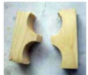
شکل ۸-۳ ج) نمونه آزمایش کشش عمود بر الیاف پس از شکسته شدن.
