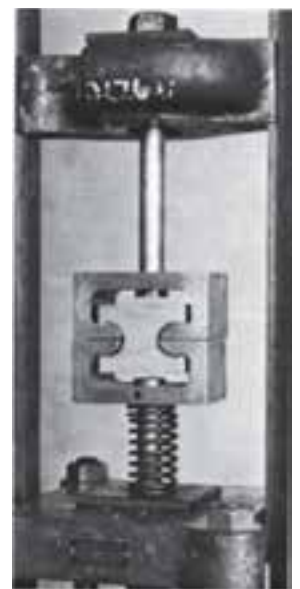
شکل ۸-۳ ب) نمونه آزمایش کشش عمود بر الیاف در حال آزمایش
