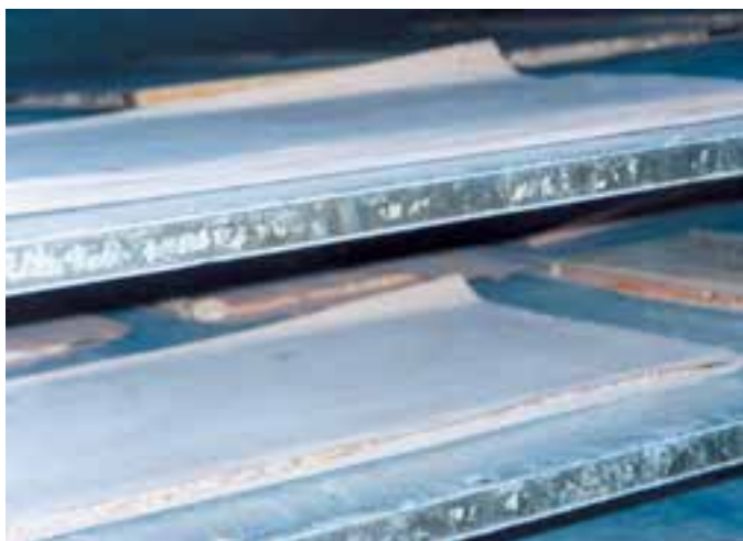
شکل ۲۰- قراردادن صفحات زیر پرس
