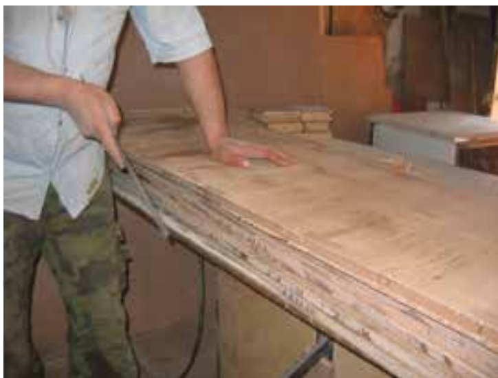
شکل ۲۲- برطرف کردن لبه های اضافی روکش
