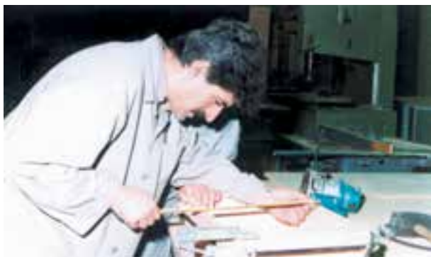
شکل ۲۹- سرهم کردن جعبه و گونیایی کردن آن
