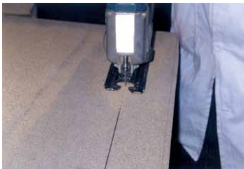
شکل ۲- بریدن نئوپان با اره‌ی عمودبر
