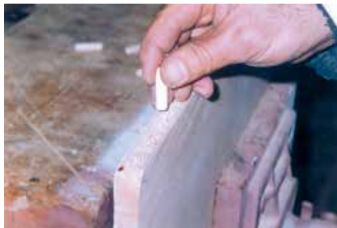
شکل ۲۵ - جازدن دوبل‌ها در نر صفحات
