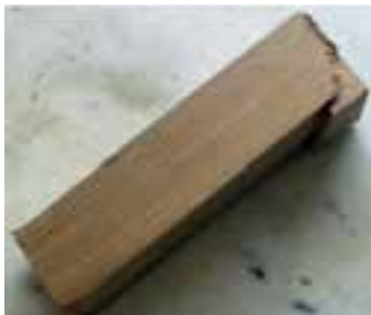
شکل ۹-۱۰، تغییر شکل دائمی ایجاد شده در چوب راش پس از آزمایش فشار موازی الیاف
