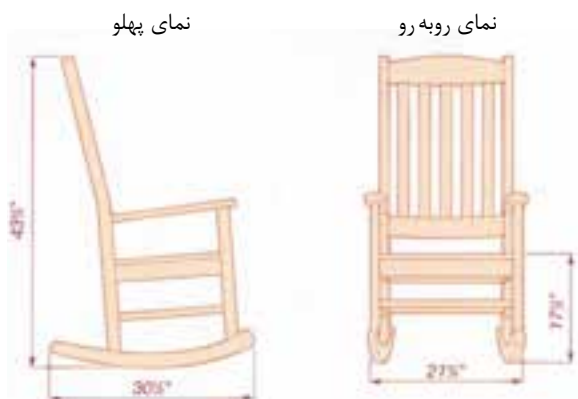
شکل ۳-۱۰۸- برای قطعات شماره یک تا چهار شابلون ویژه قوس تهیه می‌شود.
