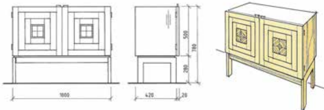
شکل ۳-۵- کابینت پایه‌دار به روش قاب‌دار
