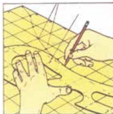
شکل ۳-۱۰۶- تطبیق پیستوله با منحنی رسم شده
