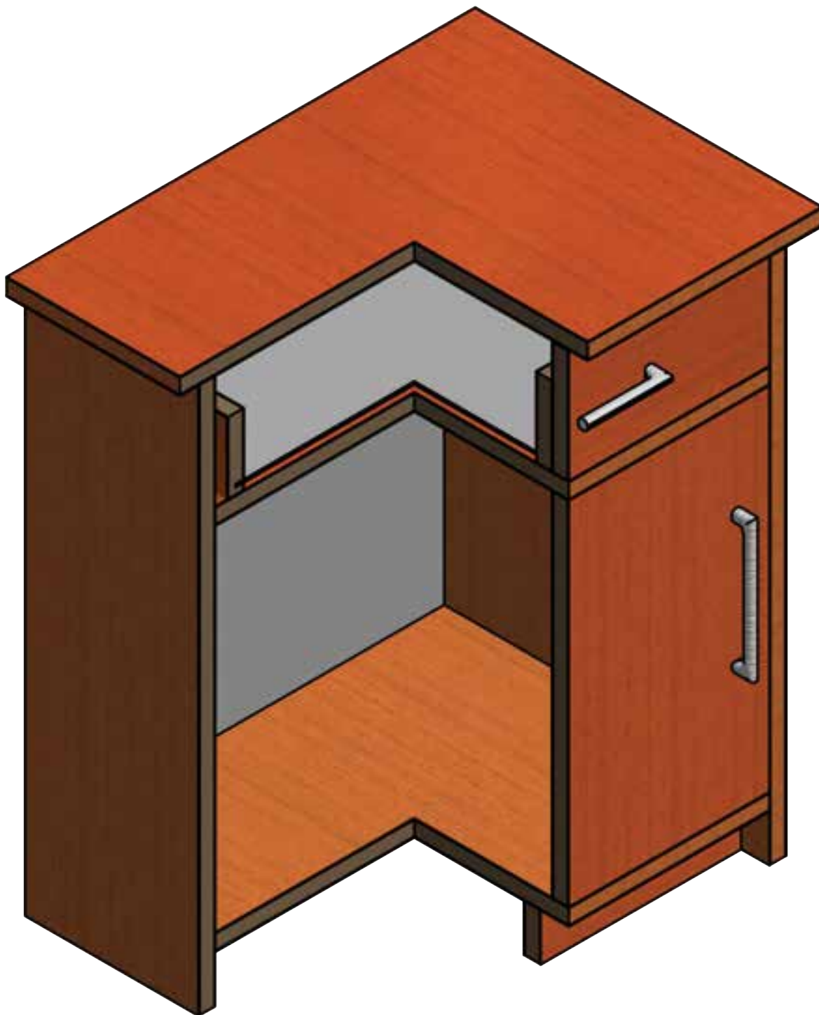
شکل ۳-۳۵ برش طولی و پیشانی پاتختی کشودار در گوشه (برش جزئی)
