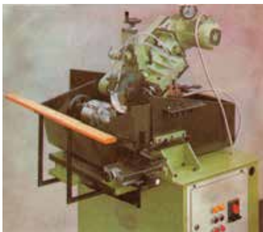
شکل ۱۱-۲- دستگاه تیغه تیزکنی
