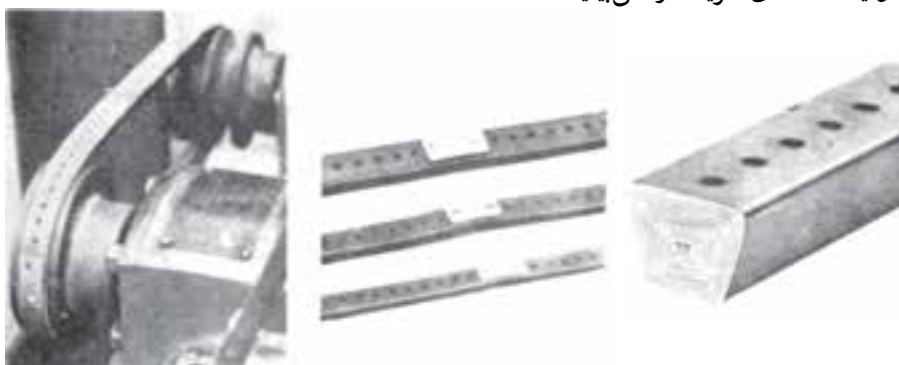
شکل ۲-۳- نمونه‌ای از اتصال در تسمه‌های متریک
