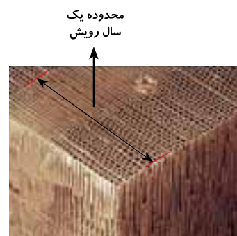
شکل ۲۷-۱- حفره تراکئیدی در بخش بهاره و تابستانه در سوزنی برگ (کاج)
