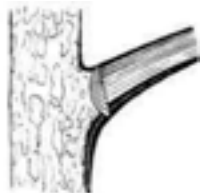
شکل ۴۴-۱- چوب فشاری
