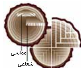
شکل ۱۴-۱ - برش شعاعی از تبدیل گرده‌بینه به الوار
