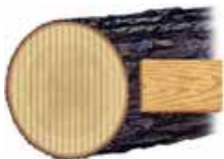
شکل ۱-۱۳ - برش مماسی از تبدیل گرده بینه
