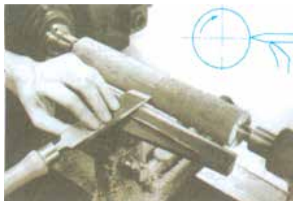
شکل ۱۲-۱۳- مغار روی تکیه‌گاه در حالت‌های مختلف تراشه‌های متفاوتی برمی‌دارد.
