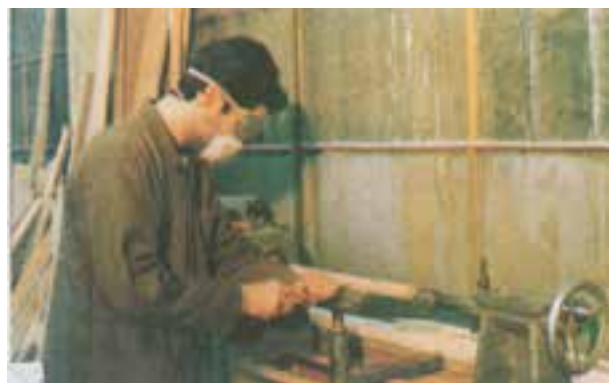
شکل ۱۳-۱۳- طرز کار با ماشین خراطی
