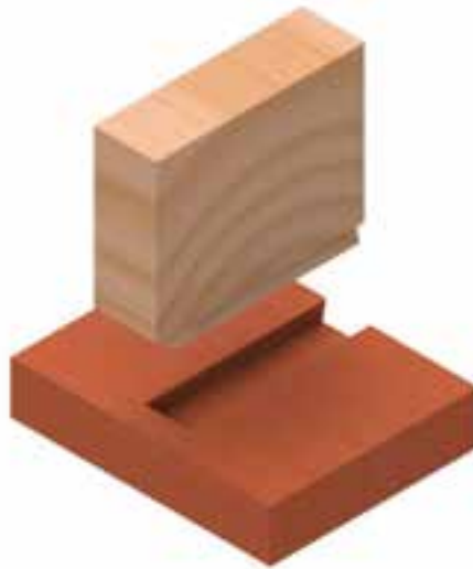
شکل ۹-۶۱- اتصال گوشه‌ی صفحات گرات - شکاف گرات و زبانه در جلو ۱ تا ۲ میلی‌متر باریک‌تر هستند.
