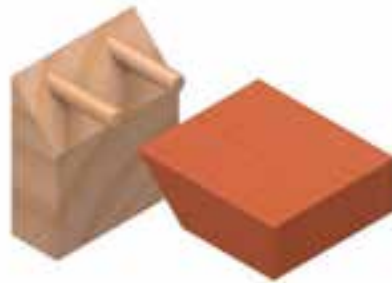
اتصال گوشه‌ی صفحات دوبل فارسی با دوبل گونیایی
