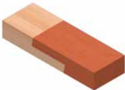
شکل ۹-۷۴- اتصال طولی نیم و نیم سرکج.
