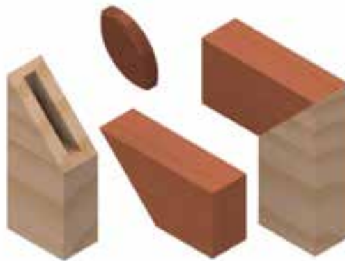
شکل ۹-۲۵- اتصال گوشه‌ای دو رو فارسی مخفی با زبانه‌ی کوتاه بیضی‌شکل (اتصال بیسکویتی).
