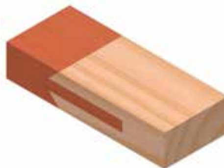
شکل ۹-۷۷- اتصال طولی فاق و زبانه‌ی سرکج.
