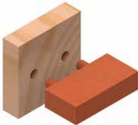
شکل ۹-۵۲- اتصال گوشه‌ی صفمات دابل با افتلاف سطح.
