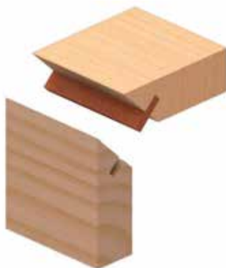
شکل ۹-۶۴- طریقه‌ی ترسیم اتصال گوشه‌ی صفحات قلیف، با زبانه‌ی پیش ساخته از مواد مصنوعی در نما.
