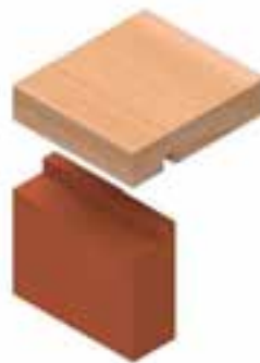
شکل ۹-۴۴- اتصال گوشه‌ی صفحات ساده، با کنشکاف و زبانه‌ی پخ فورده.
