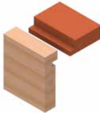
شکل ۹-۴۳- اتصال گوشه‌ی صفحات ساده، با کنشکاف و زبانه.
