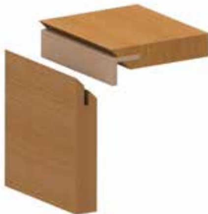
شکل ۹-۶۳- اتصال گوشه‌ی صفحات قلیف، با زبانه‌ی پیش ساخته از مواد مصنوعی.
