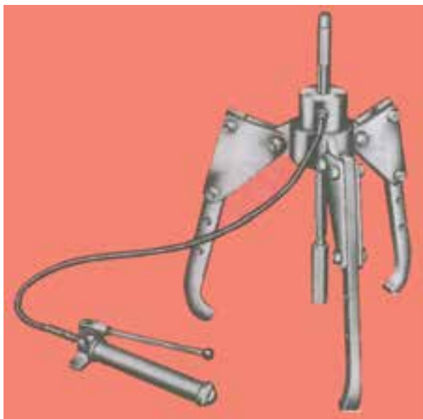
شکل ۱۲-۶۸- پولی کش با سیستم فشار هیدرولیکی
