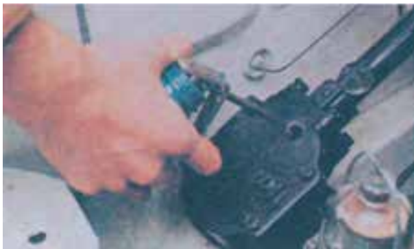
شکل ۱۲-۴۳- نحوه ی کاربرد روغندان
