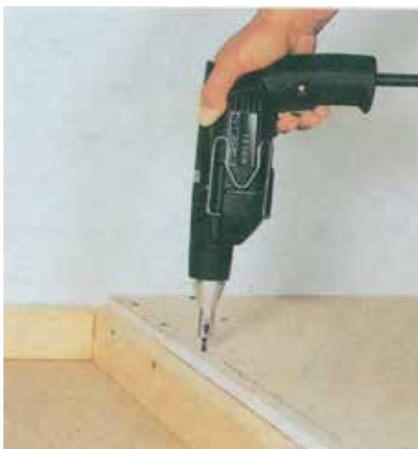
شکل ۱۲-۱۲- نحوه‌ی کاربرد دریل پیچ‌گوشتی برقی دستی ساده
