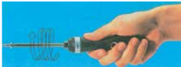
شکل ۹-۱۲- بستن سریع پیچ با آچار پیچ‌گوشتی خودکار
