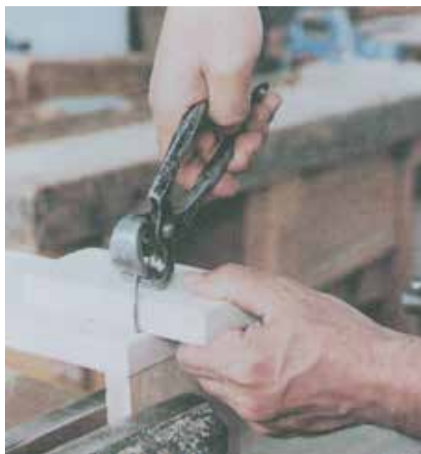
شکل ۱۱-۱۸- طریقه‌ی استفاده از گازانبر
