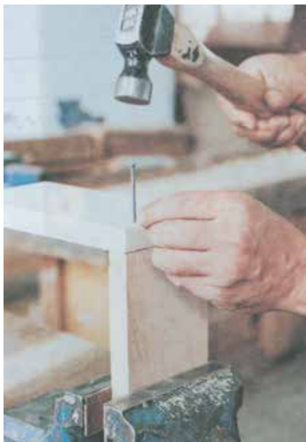
شکل ۱۱-۱۲- نحوه‌ی میخ‌کوبی
