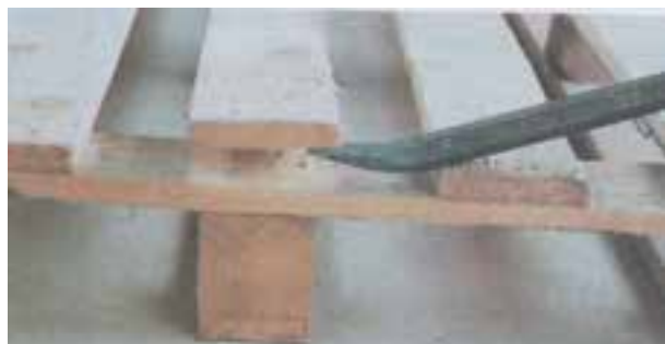
شکل ۱۱-۱۵- نحوه‌ی خارج کردن سر میخ
