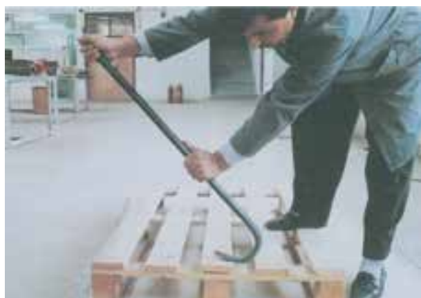
شکل ۱۱-۱۶- طریقه‌ی میخ‌کشی به وسیله‌ی میخ‌کش اهرمی
