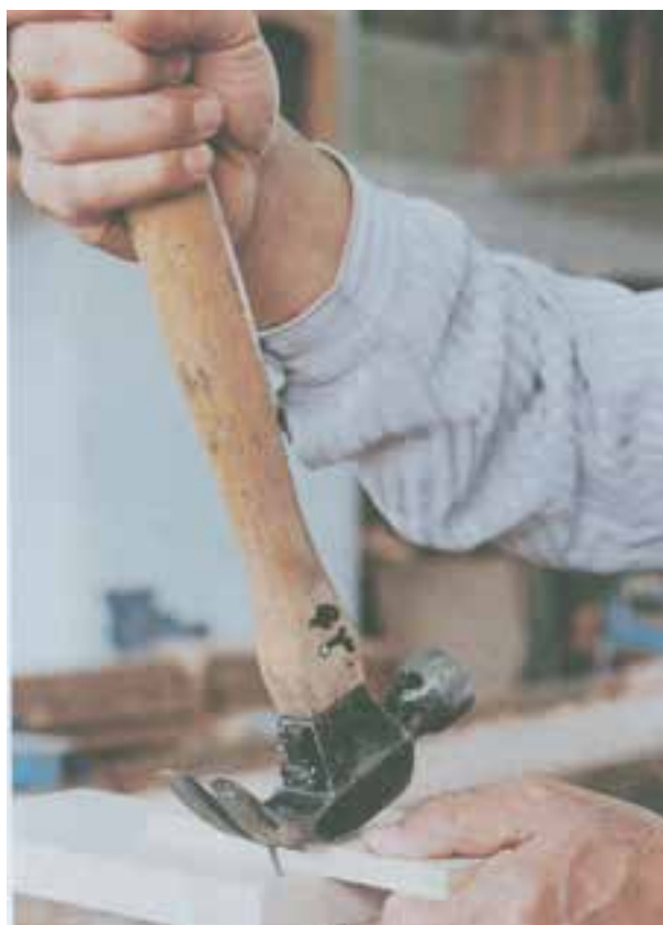
شکل ۱۱-۲۱- طریقه‌ی استفاده از میخ‌کش چکشی
