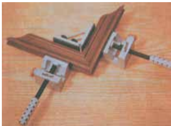
شکل ۱۲-۱۰ پیچ دستی مخصوص گوشه‌های کار
