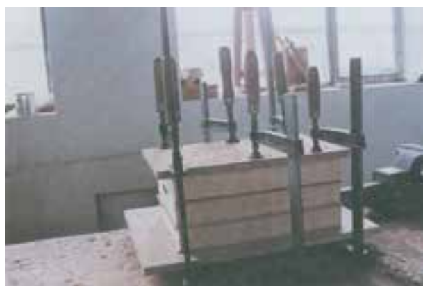
شکل ۶-۱۰ نحوه‌ی بستن پیچ دستی روی تعدادی از قطعات چوب خورده
