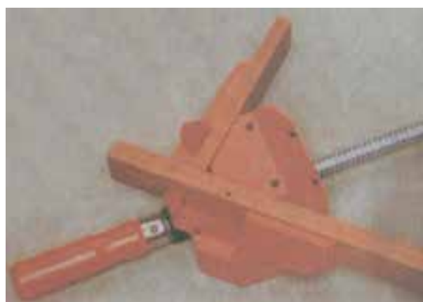
شکل ۱۶-۱۰- یک نوع گیره مخصوص قاب
