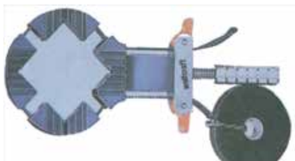
شکل ۱۷-۱۰- یک نوع از گیره‌های کمربندی (تسمه‌ای طنابی)
