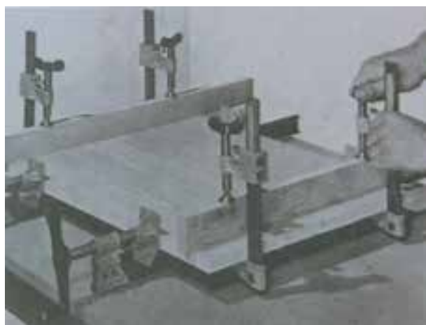
شکل ۴۵-۱-۰: طریقه‌ی چسباندن اتصال عرضی درزی ساده با استفاده از تنگ و گیره‌های دستی
