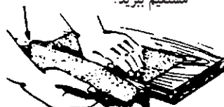
شکل ۹-۷- نحوه‌ی عمل قطع کردن سنبلاده، سنبلاده کاری باید در جهت الیاف چوب باشد.
