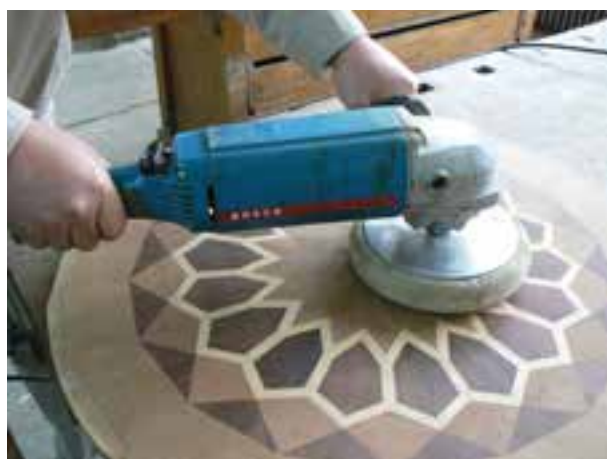
شکل ۹-۲۰- ماشین سنباده دیسکی را می‌توانید به عنوان پولیش کاری در رنگ‌های پولیستر به کار ببرید.
