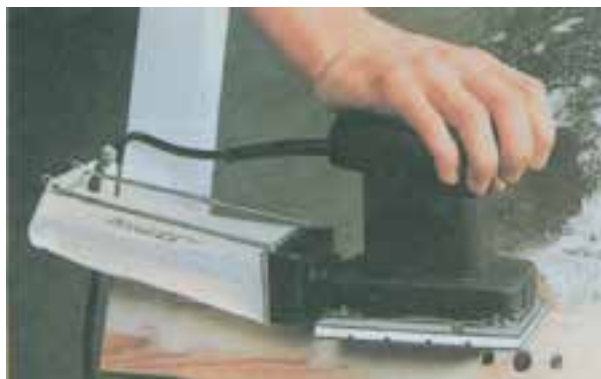
شکل ۹-۳۶- به وسیله‌ی ماشین‌های سنباده لرزشی کوچک (مشتی) می‌توانید سطوح کوچک را جهت آستری و رنگ‌کاری سنباده‌کاری کنید.
