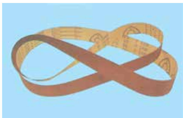
شکل ۹-۳- با چسبانیدن دو سر سنباده نواری به یک دیگر آن را جهت ماشین آماده سازی.
