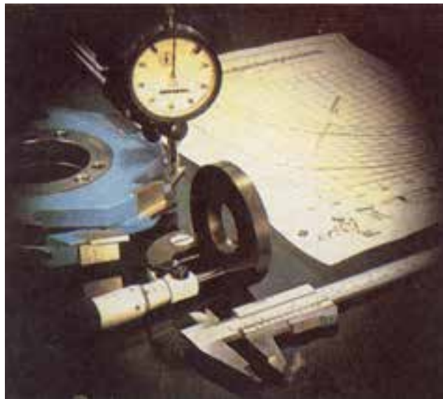
شکل ۸-۱۷- ابزارهای اندازه‌گیری از فولاد کربنی مخصوص
