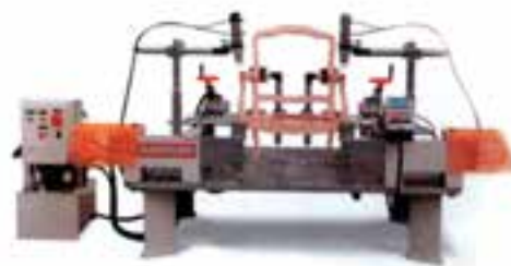
شکل ۶-۷- پرس مونتاز صندلی جهت میل و صندلی‌سازی
