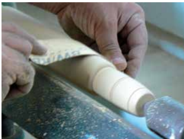
شکل ۹-۵- نحوه سنباده زدن با ماشین خراطی
