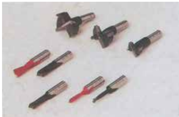
شکل ۸-۴۹- انواع تیغ های مخصوص ماشین جای لولای کابینتی
