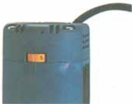
شکل ۳۱-۸- روشن و خاموش کردن و تغییرات دور به وسیله‌ی کلید مربوط انجام می‌شود.
