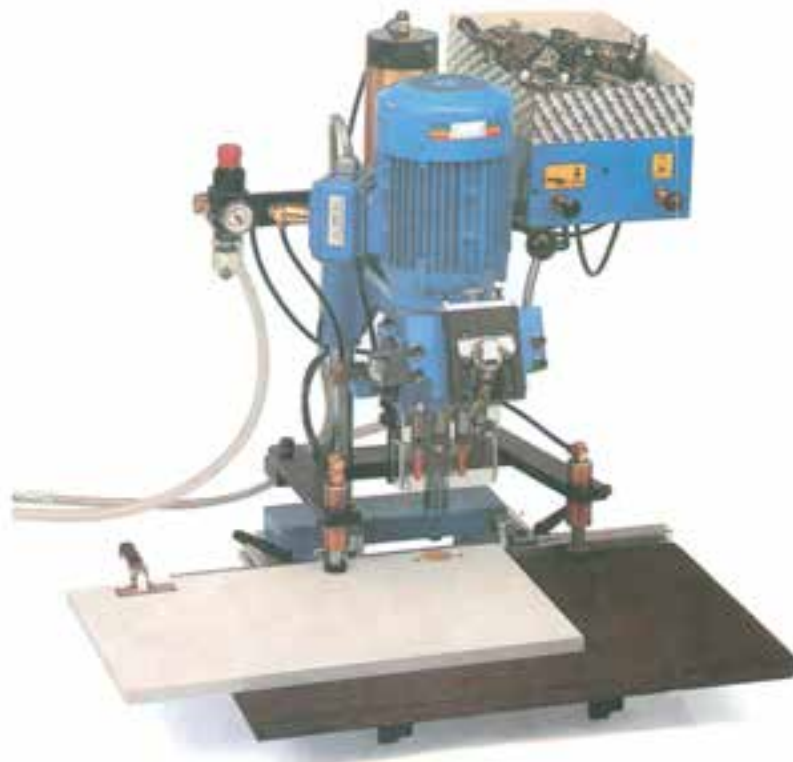
شکل ۸-۴۸- ماشین فرز مخصوص جهت درآوردن جای لولای کابینتی، در این ماشین قطعه کار به‌وسیله‌ی دو کفشک پنوماتیکی روی صفحه نگه‌داری می‌شود.
