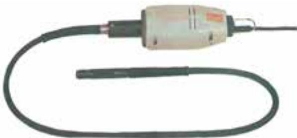
شکل ۸-۴۱ - الکتروموتور و میله خرطومی همراه با سه نظام مخصوص با دور ثابت و مستقیم
