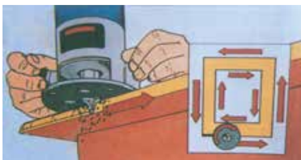
شکل ۸-۲۷ با تکیه‌دادن تیغ فرز به راهنما و تکیه‌گاه پایه به لبه‌ی کار می‌توان نو (لبه) صفحات را فرز کاری کرد.
