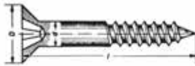
شکل ۹۴-۲ پیچ سرمخروطی برآمده
