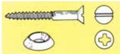
شکل ۲-۹۸- پیچ سرتخت خزینه ای
