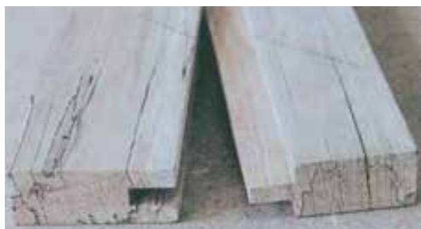
شکل ۷-۴۷- کنشکاف و قلیف با زبانه سرخود
