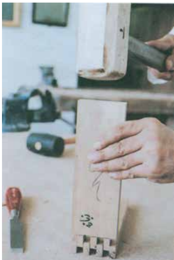
شکل ۳۷-۷: طریقه داخل کردن فاق و زبانه
