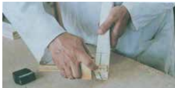
شکل ۷-۸ به‌وسیله‌ی تیره‌دار محل اتصال را خط بکشید.
