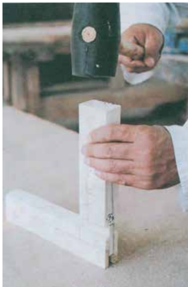
شکل ۷-۲۱- طریقه اتصال فاق و زبانه‌ی گوشه‌ای
