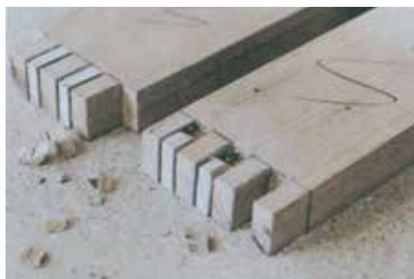
شکل ۷-۳۶- درآوردن کل قسمت‌های اضافی از طرف دیگر
