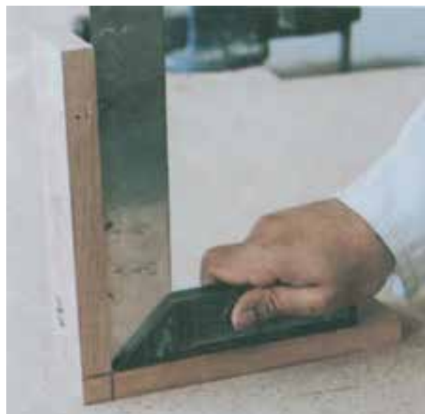
شکل ۳۸-۷: کنترل کردن اتصال ساخته شده
