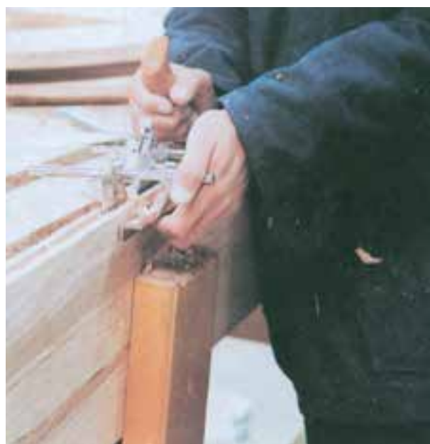
شکل ۷-۴۴- رنده کردن به وسیله‌ی رنده کنشکاف
