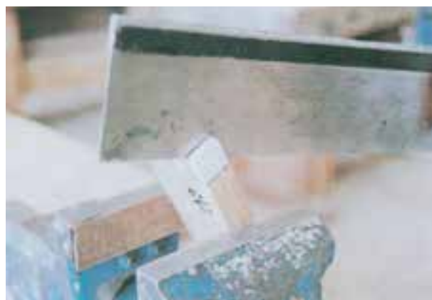
شکل ۷-۲۹- عمل برش با زاویه 45^\circ درجه
