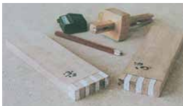
شکل ۲۸-۷. اتصال انگشتی خط‌کشی شده
