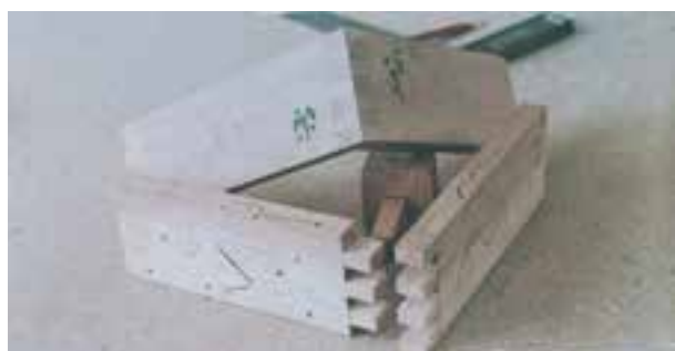
شکل ۳۹-۷: اتصال انگشتی ساده
