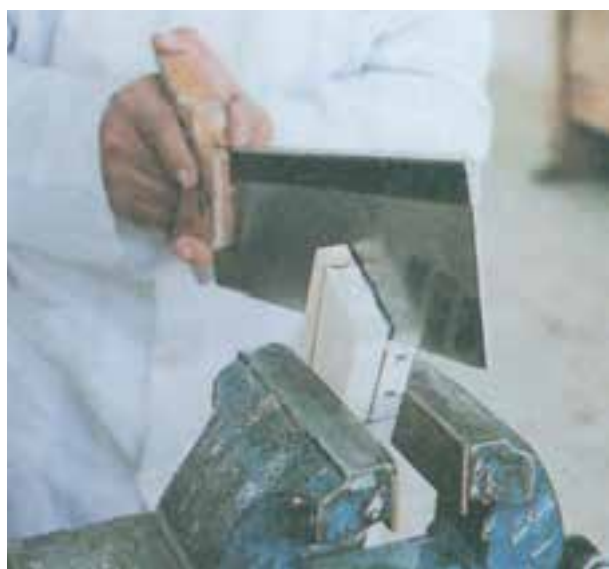
شکل ۷-۱۰ طریقه برش اتصال نیم و نیم
