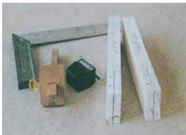
شکل ۷-۹ چوب‌های خط‌کشی‌شده برای اتصال نیم و نیم
