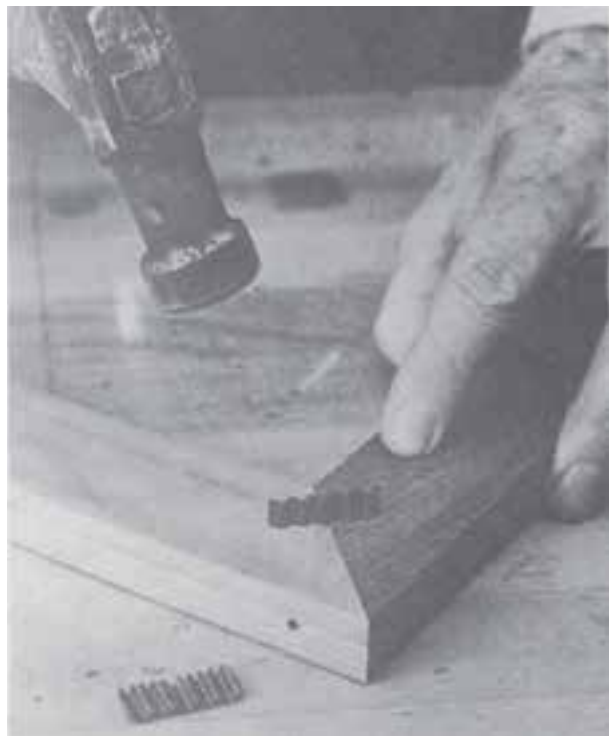
شکل ۶۶-۷- سوزن دوخت زیگزاگی (تیغه‌ای)
