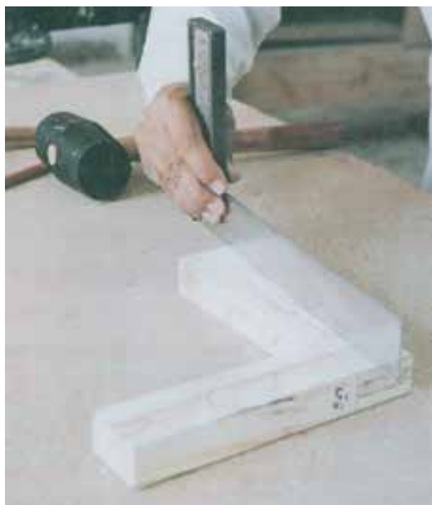
شکل ۷-۲۲- طریقه‌ی کنترل اتصال گوشه‌ای
