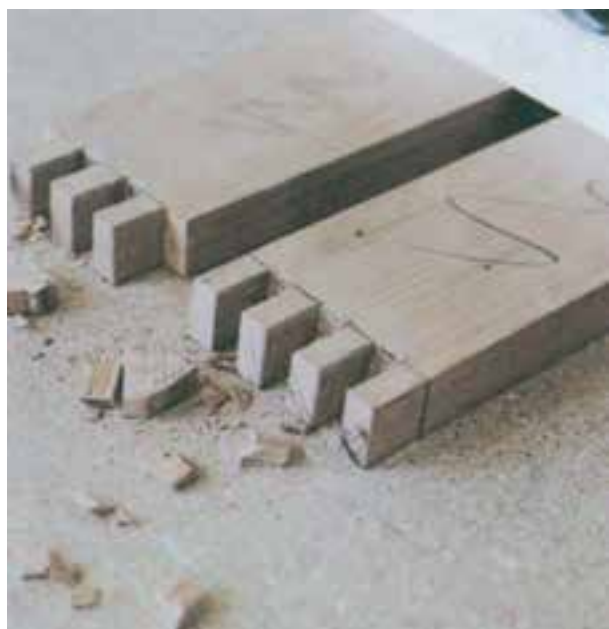
شکل ۷-۳۵- قسمت‌های اضافی فایق و زبانه درآورده شده است.
