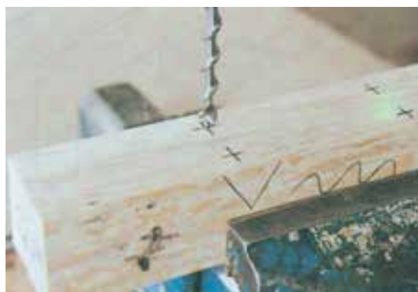
شکل ۷-۵۱- استقرار نیش‌مته در مرکز سوراخ
