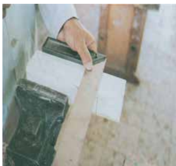
شکل ۷-۷ به‌وسیله گونیا چوب را خط‌کشی کنید.
