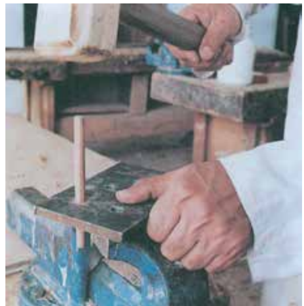
شکل ۷-۵۵- عبور دادن میخ چوبی از آهن دوپل
