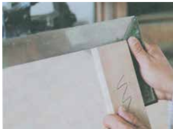
شکل ۲۵-۷. کنترل قطعه چوب آماده شده
