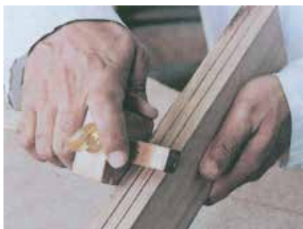
شکل ۷-۴۳- خط‌کشی کنشکاف قلیف با خط‌کش تیره‌دار
