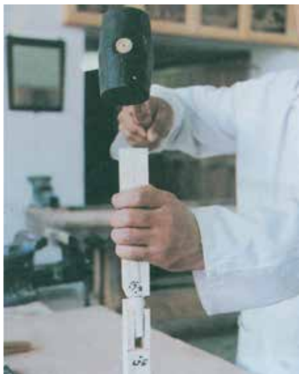
شکل ۷-۱۹- طریقه متصل کردن فاق و زبانه
