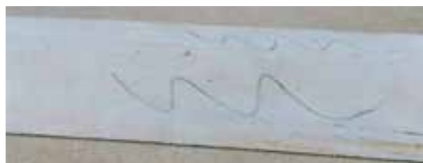
شکل ۷-۳- روی سطح رنده شده علامت بگذارید.
