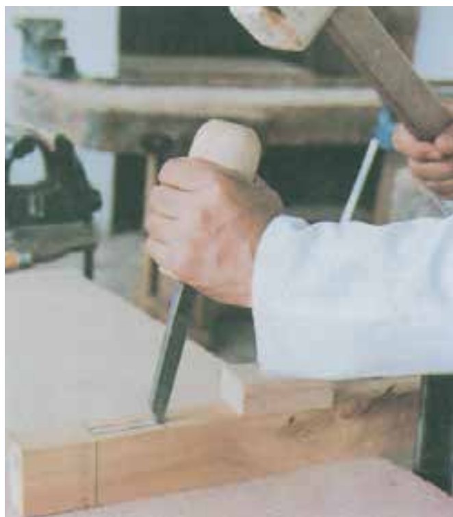
شکل ۶-۲۰- اسکنه کج قرار داده شده و اشتباه است
