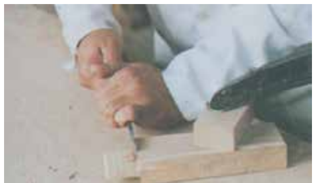
شکل ۱۴-۶ طریقه‌ی تسطیح انتهای زبانه
