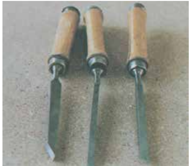
شکل ۱۲-۶ مغار در دسته کج قرار گرفته
