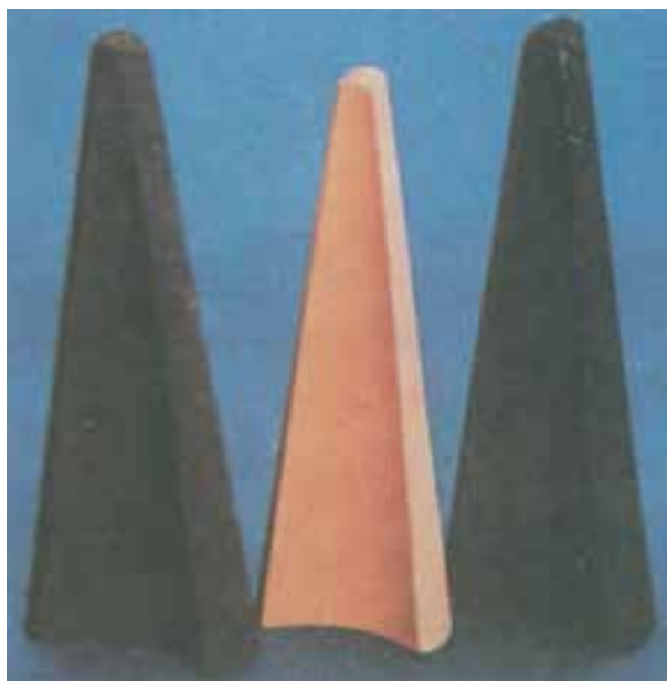
شکل ۶-۴۰ – سنگ سنباده مخصوص تیزکردن مغارهای فرم‌دار
