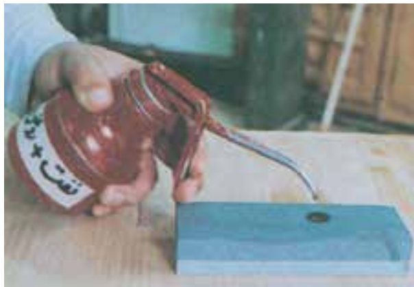
شکل ۶-۳۴- روغن زدن یا نفت زدن روی سنگ
