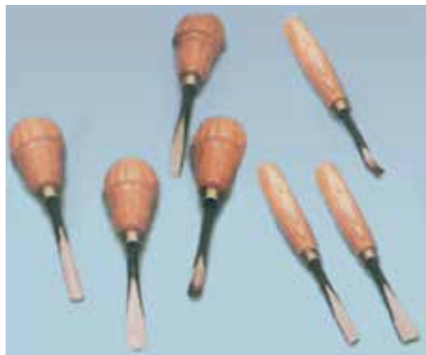
شکل ۶-۲۵- مغارهای تخت و نیم‌باز
