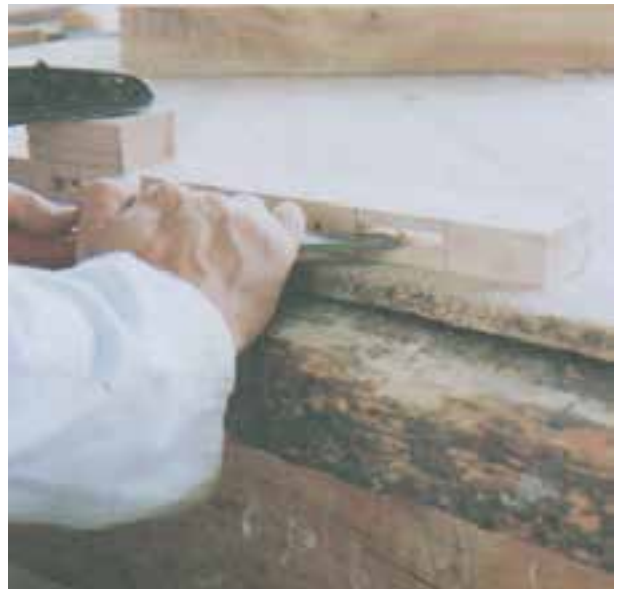
شکل ۱۳-۶ نحوه‌ی خالی کردن کُم با مغار
