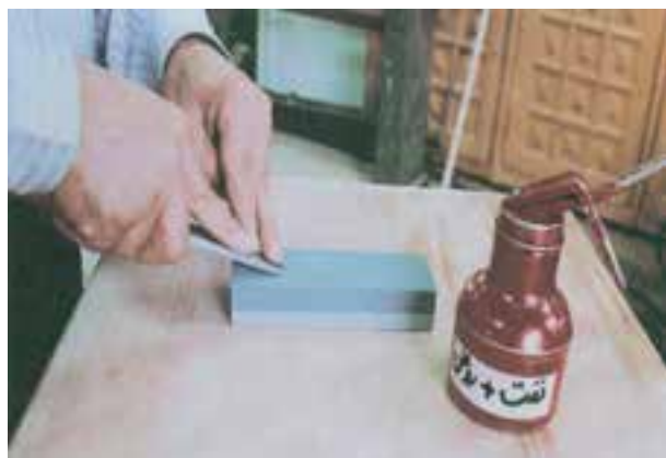
شکل ۶-۳۵- طریقه کشیدن تیغ مغار روی سنگ نفت
