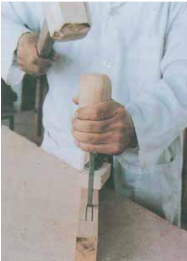
شکل ۶-۱۸- طریقه‌ی کاربرد اسکنه
