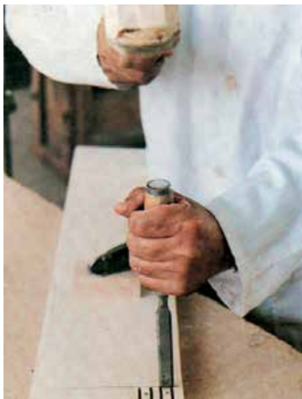
شکل ۶-۸- نحوه‌ی ضربه زدن به سر دسته‌ی مغار
