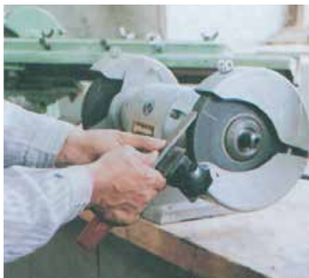
شکل ۶-۳۱- تنظیم تکیه‌گاه برای تیزکردن مغار
