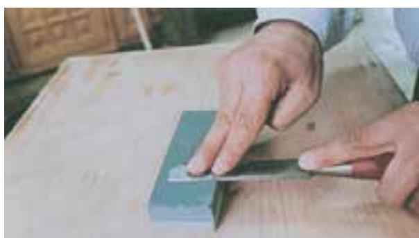
شکل ۶-۳۶- طریقه برطرف کردن پلیسه
