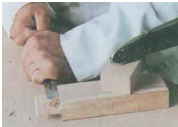
شکل ۶-۴ صاف کردن اطراف زبانه با مغار
