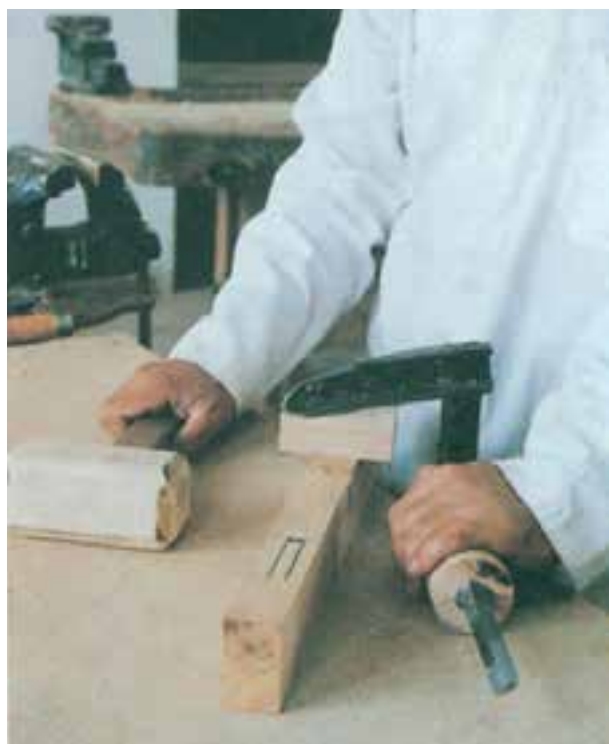
شکل ۶-۲۱- نحوه‌ی استقرار قطعه کار روی میز کار
