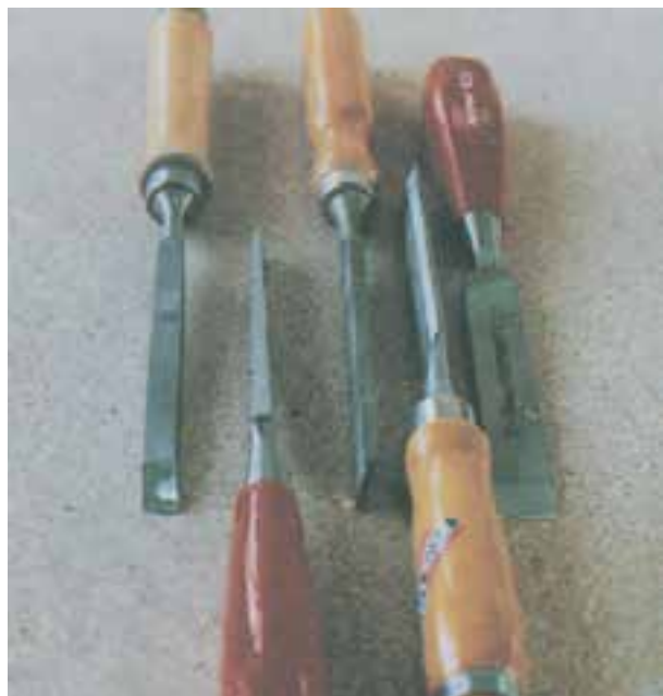
شکل ۱۱-۶- شکستگی نوک مغار
