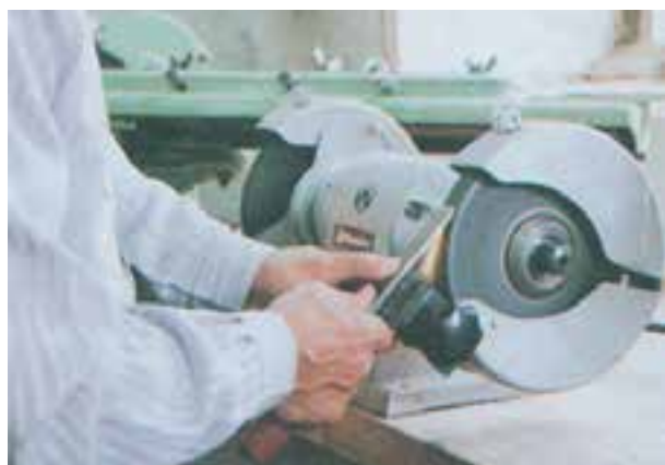
شکل ۶-۳۲- طریقه‌ی تیزکردن تیغه‌ی مغار
