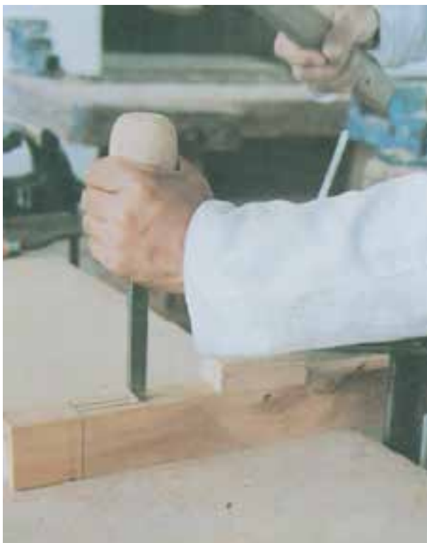
شکل ۶-۱۹- اسکنه عمود قرار داده شده
