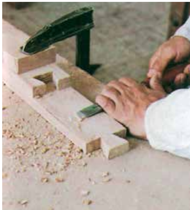
شکل ۶-۵ صاف کردن سطح اتصال با مغار
