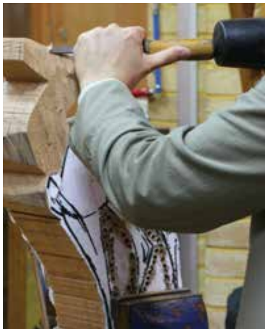
شکل ۲۹-۶- طریقه‌ی منبت‌کاری
