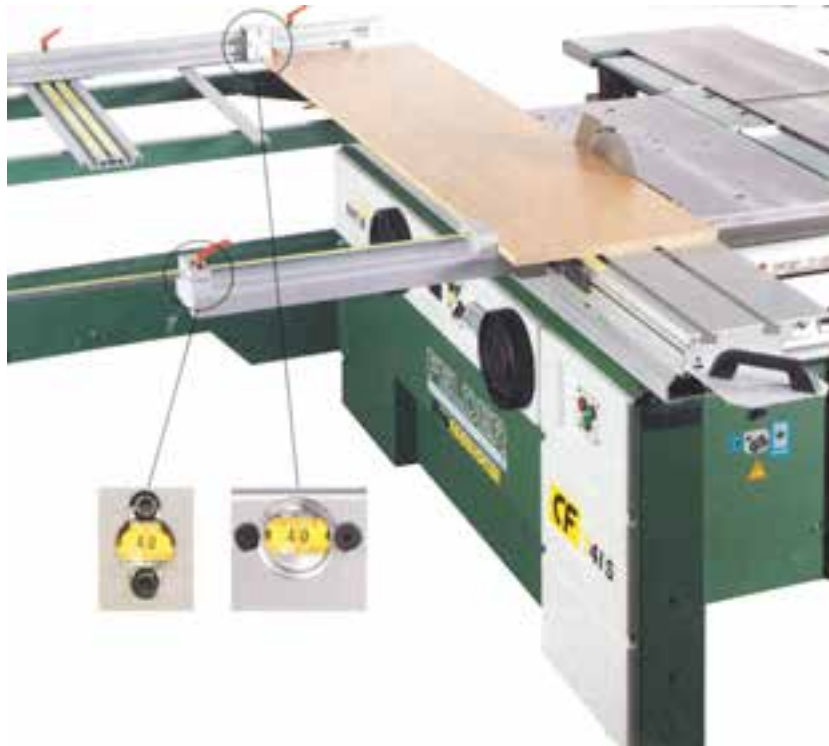
شکل ۱-۳۸- ماشین اره گرد صفحه بر با میز کمکی کشونی
