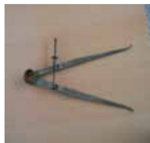
شکل ۱-۱۱- قیچی برای قطع کردن تیغه اره نواری
