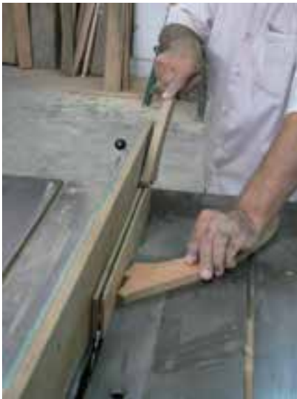
شکل ۱-۴۰- روش کنشکاف زدن
