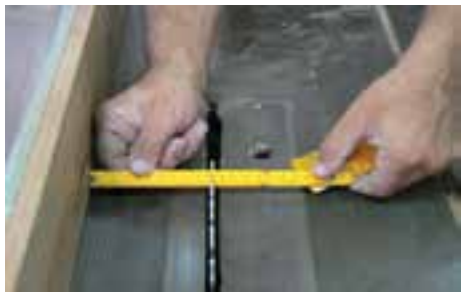
شکل ۱۹-۱-روش تنظیم گونیای ااره مجموعه‌ای برای تنظیم عرض برش
