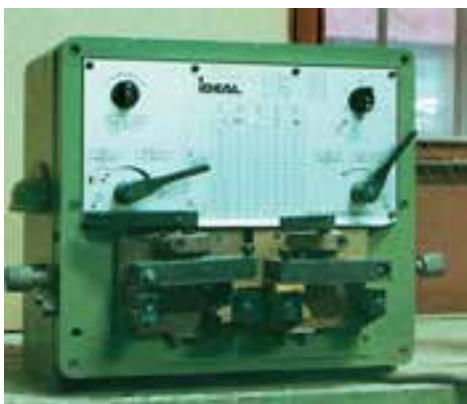
شکل ۱-۱۲- دستگاه جوش تیغه اره نواری
