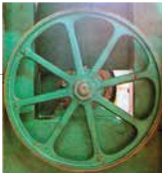
شکل ۴-۱- فلکه پایین اره نواری به همراه بانداز
