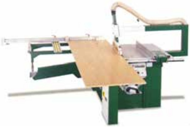
شکل ۱-۳۷- ماشین اره گرد با میز کمکی کشونی
