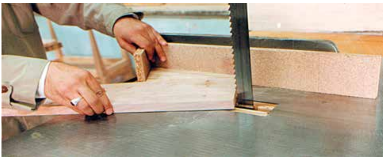
شکل ۱۵-۱- روش استفاده از شابلون برای برشهای مثلی
