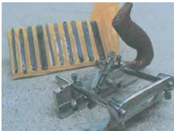
شکل ۵-۵۲- رنده کنشکاف با تیغه‌های مختلف
