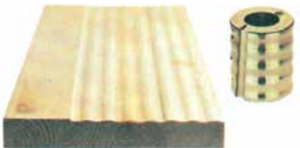
شکل ۵-۸۰- دو نوع تویی رنده برقی برای فرم دادن سطح چوب‌ها
