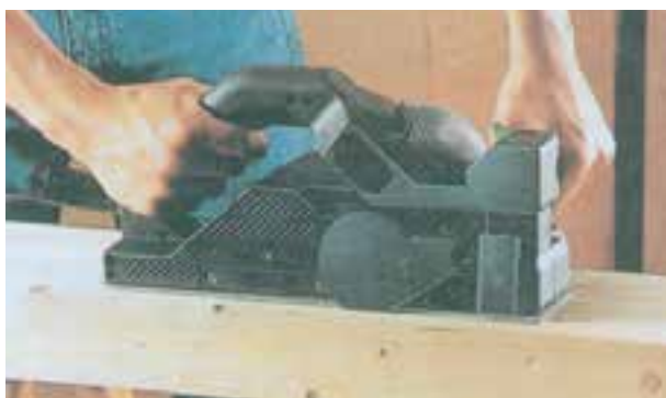
شکل ۵-۶۹- نحوه استقرار دست‌ها در عملیات رنده‌کاری
