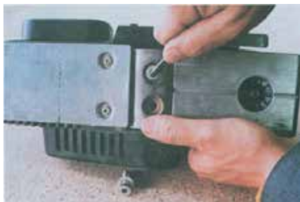
شکل ۵-۸۳- محکم کردن پیچ‌های ثابت کردن تیغه‌ها
