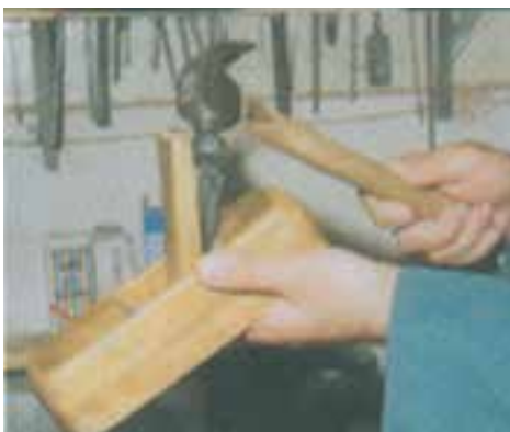
شکل ۱۱-۵ تنظیم جانبی تیغه
