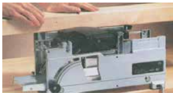
شکل ۷۱-۵ طریقه‌ی هدایت چوب روی رنده
