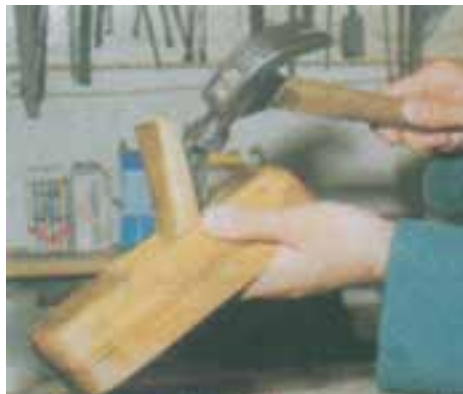
شکل ۱۱-۵ تنظیم جانبی تیغه
