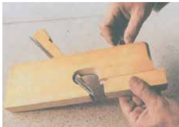
شکل ۵-۴۰- نحوه ی تنظیم دهانه پوشال
