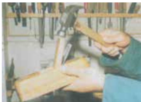
شکل ۱۰-۵ تنظیم تیغه با ضربه‌ی چکش
