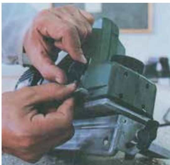
شکل ۵-۷۸ تنظیم رنده برقی برای دوراهه زدن
