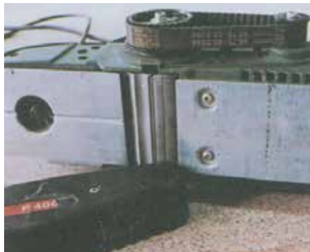
شکل ۵-۸۵- کنترل تسمه انتقال دور ماشین
