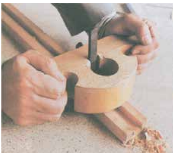
شکل ۵-۴۹- نحوه‌ی ایجاد کنشکاف طرح فرنگ با رنده چوبی مخصوص
