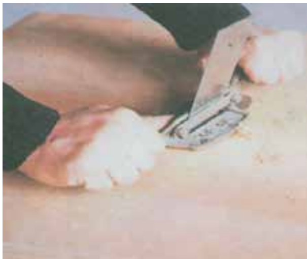
شکل ۵-۵۸- نحوه‌ی استفاده از رنده لیسه
