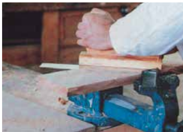
شکل ۵-۳۲ نحوه کاربرد رنده خشی
