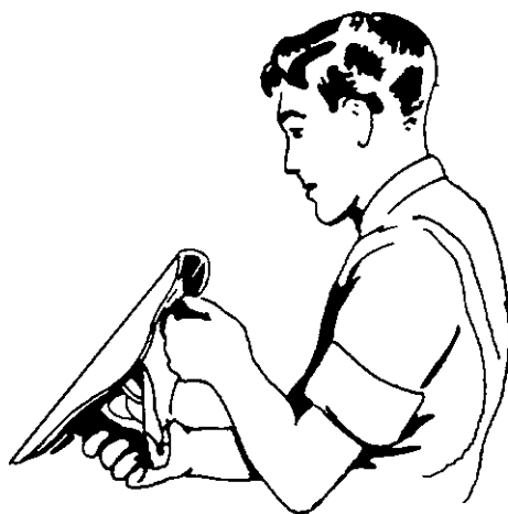
شکل ۵-۵- نحوه ی تنظیم رنده
