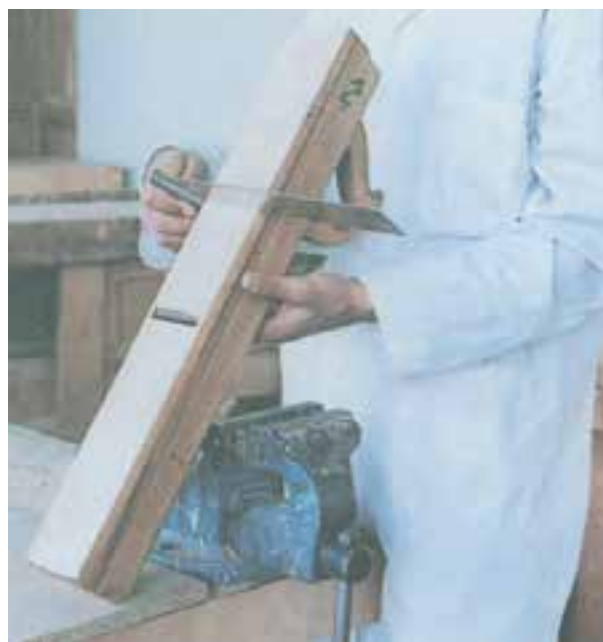
شکل ۵-۳۰ کنترل عرضی سطح رنده
