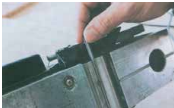
شکل ۵-۸۲- نحوه‌ی استقرار تیغه در تویی
