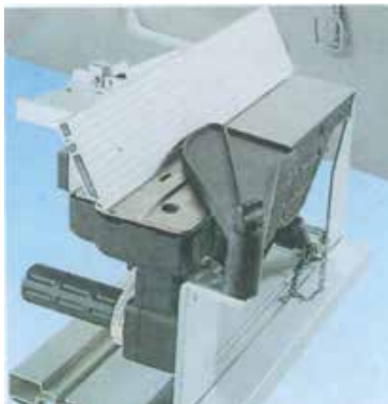
شکل ۵-۷۷ پخ زدن با ثابت کردن رنده
