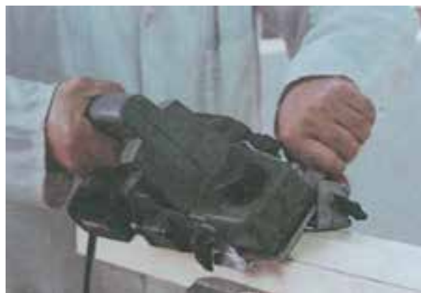
شکل ۵-۷۶ طریقه پخ زدن به چوب
