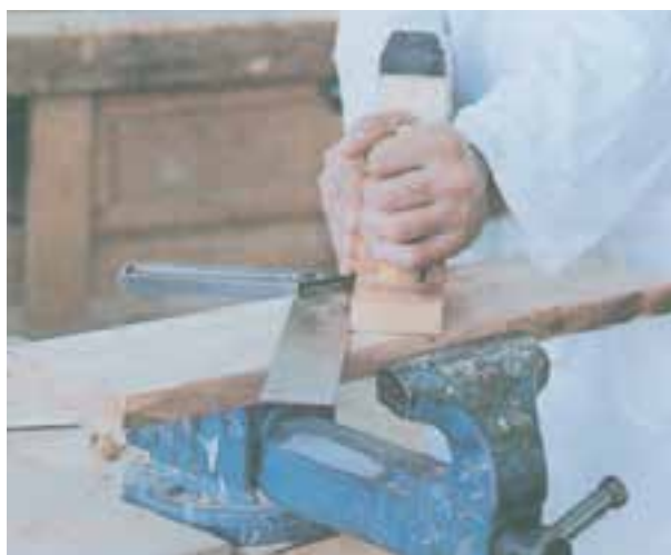
شکل ۳۴-۵ نحوه‌ی رنده کردن مجدد با رنده خشی
