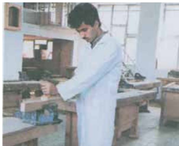
شکل ۱۷-۵ - نحوه‌ی کاربرد رنده یک تیغ
