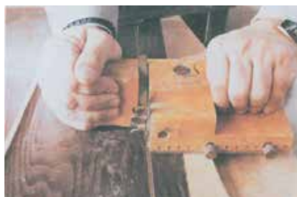
شکل ۵-۵۴- نحوه ایجاد شیار برای نصب مغزی
