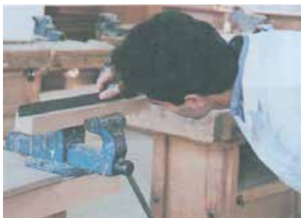
شکل ۲۳-۵- کنترل صافی سطح رنده شده
