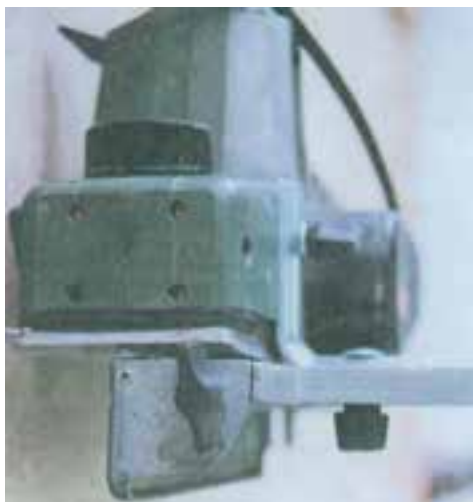
شکل ۵-۶۷- تنظیم رنده برای رنده کردن سطوح تخت
