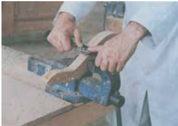
شکل ۵-۵۷- نحوه‌ی استفاده از رنده بال کبوتری
