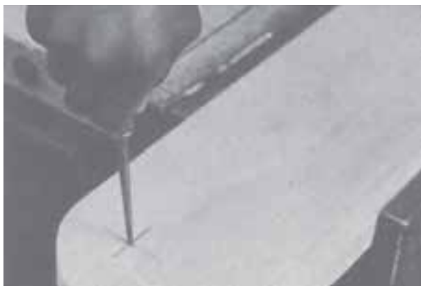
شکل ۴-۲۱- مرکز سوراخ را با درفش یا مته نازک کمی گود کنید.
