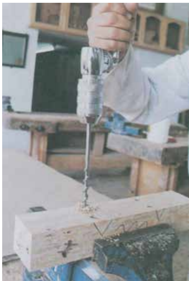
شکل ۲۳-۴- به وسیله گونیای ۹۰ درجه از مستقیم بودن دریل اطمینان حاصل کنید.
