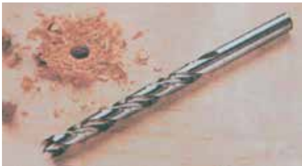
شکل ۴-۱۹- یک نوع مته‌ی مارپیچ
