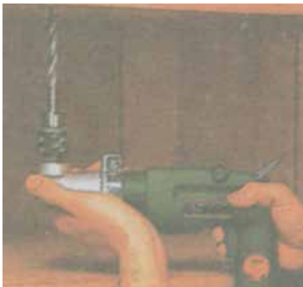
شکل ۴-۹ - دریلی که قطعه زانویی به آن سوار شده است.
