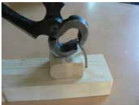
میخکشی با گازانبر با استفاده از تکیه گاه
