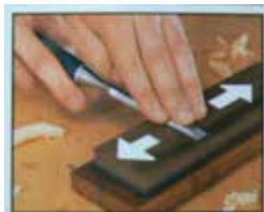
شکل ۵-۴۶ - طریقه تیز کردن مغار
