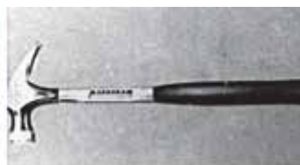
شکل ۵-۷ - چکش میخ‌کش و روش استفاده از آن
