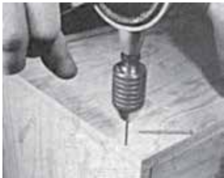
قبل از میخکاری با مته مناسب سوراخ کنید.
