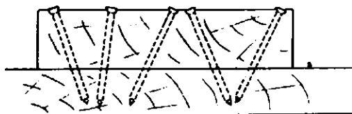
شکل ۵-۷۴- کوبیدن میخ به صورت دم چلچله
