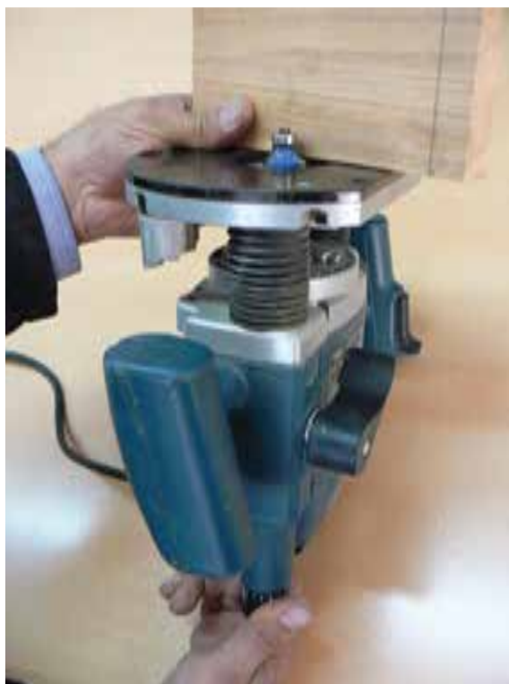
شکل ۱۲۷-۵- روش تنظیم تیغه
