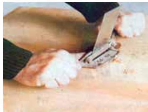
شکل ۳-۶- نحوه استفاده از رنده لیسسه
