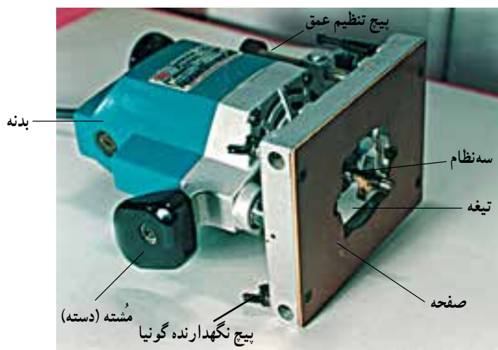
شکل ۱۲۵-۵ - مشخصات فرز دستی برقی
