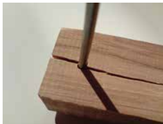
شکل ۵-۷۲- ترک خوردن راه الیاف
