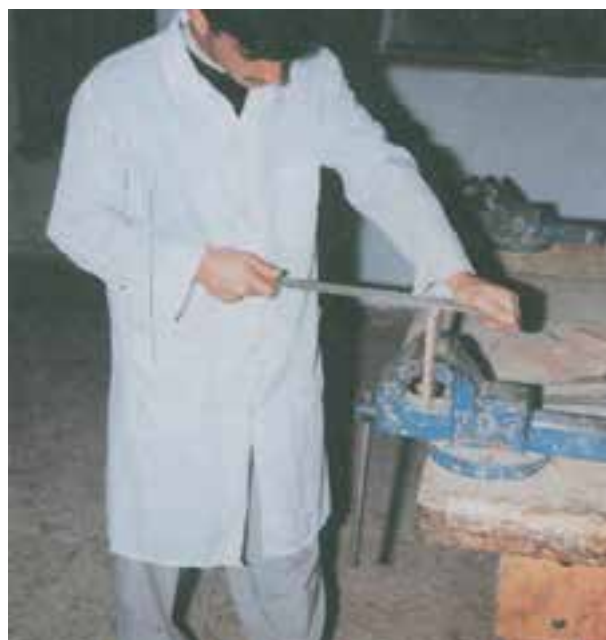
شکل ۳-۳- نحوه‌ی ایستادن جهت سوهان کاری و چوبساکاری
