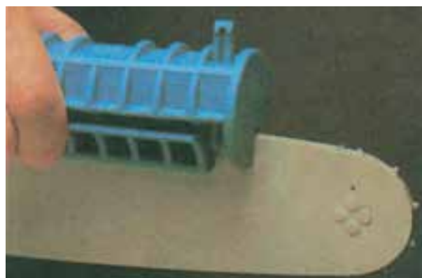
شکل ۳-۳۸- نوعی سوهان با تکیه‌گاه مخصوص ضخامت صفحات
