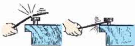
شکل ۴۸-۳- استفاده غلط از سوهان
