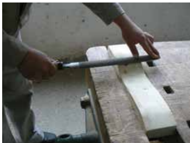
شکل ۳-۹- نحوه‌ی استقرار در مقابل قطعه کار و شروع عمل سوهان کاری
