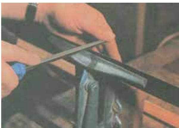
شکل ۳-۲۴- تیزکردن اره با سوهان سه گوش
