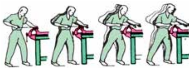
شکل ۳-۱۱- حرکت نوسانی بدن در سوهان کاری و چوبساکاری
