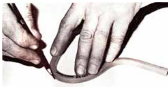
شکل ۲-۵۴- نمونه‌ی ترسیم خط منحنی توسط پیستوله‌ی ماری.
