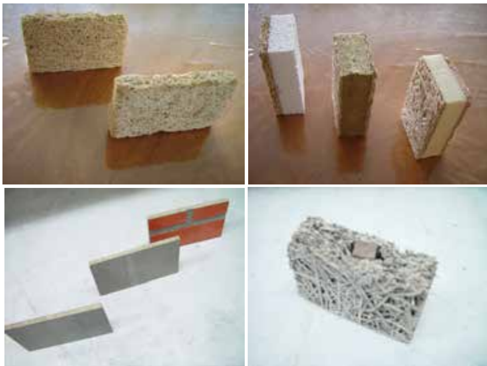
شکل ۱-۷۶- نمونه‌هایی از بانل‌های چوبی با اتصال معدنی
