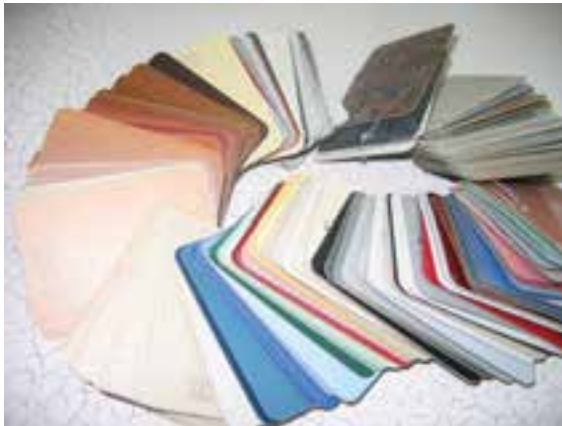
شکل ۶۶-۱- نمونه‌هایی از انواع روکش‌های ملامینه فشرده (HPL)
