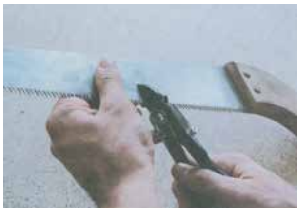
شکل ۲-۶۶ خم کردن یک طرف دندان‌ها به صورت یک در میان
