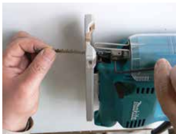
شکل ۲-۴۵ بازکردن تیغه به وسیله‌ی آچار آلن
