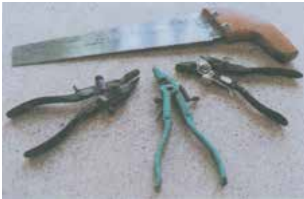
شکل ۲-۶۴- بستن چپ و راست کن اره
