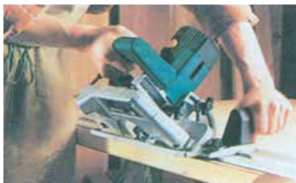
شکل ۲-۳۰- برش به وسیله‌ی اره مجموعه‌ای به کمک صفحه راهنما
