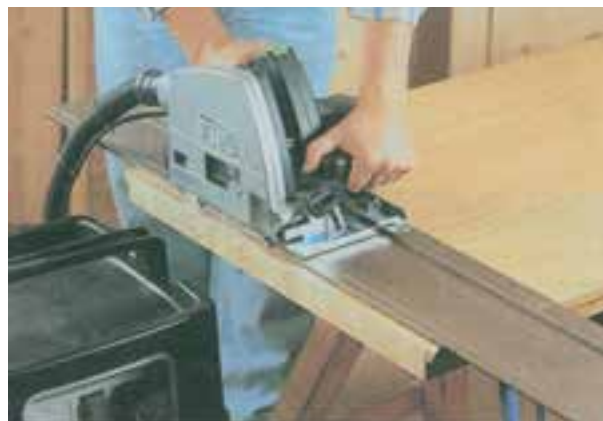
شکل ۲-۳۱- برش در خط مستقیم به وسیله‌ی اره‌ی مجموعه‌ای همراه با مکند
