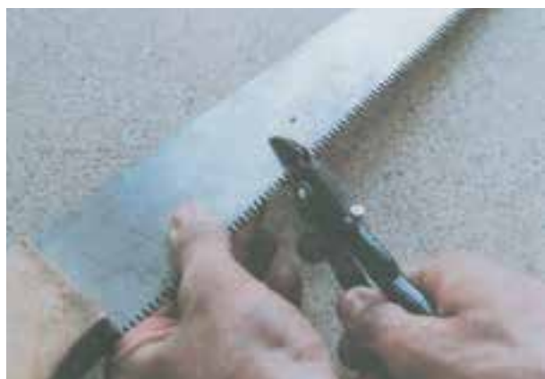
شکل ۲-۶۷ برگرداندن و خم کردن دندان‌های خم نشده
