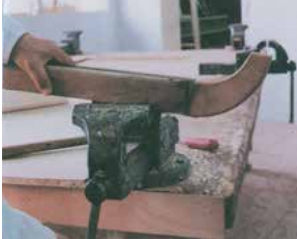
شکل ۲-۶۲- آهن چپ و راست کن دندانهای اره
