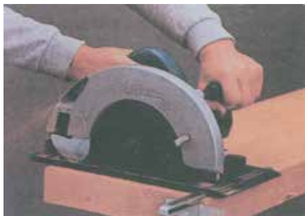
شکل ۲-۲۶- برش به وسیله‌ی گونیای دستگاه
