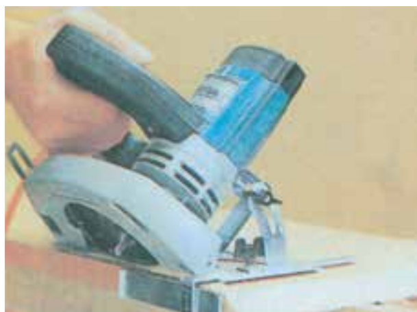
شکل ۲-۲۹- برش تحت زاویه به وسیله‌ی گونیای دستگاه
