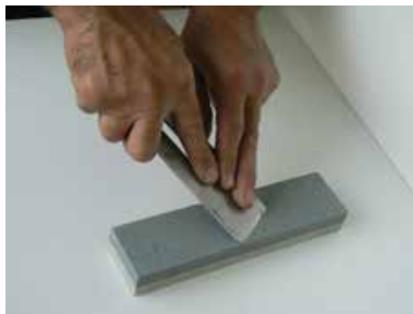
شکل ۳۴-۳ - روش سنگ نفت زدن تیغه رنده
