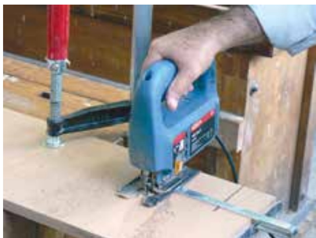
شکل ۲-۲۹ - استفاده از گونیا در برش
