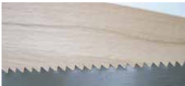
شکل ۱۱-۲- دندانه های اره شکاف زن
