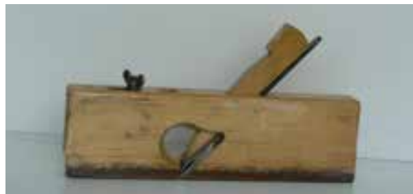
شکل ۳-۲۷ رنده چوبی کنشکاف قابل تنظیم
