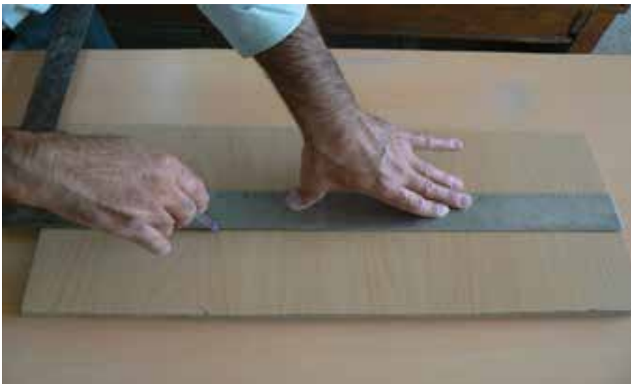
شکل ۹-۱- بر راستی و روش استفاده از آن
