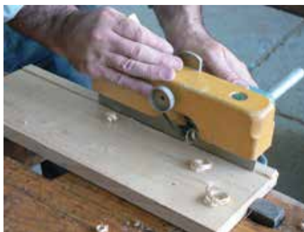
شکل ۳-۲۸ رنده چوبی کنشکاف قابل تنظیم
