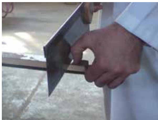
شکل ۲-۳۳- در شروع کار بعد از ایجاد شیار اولیه برش دست را از کنار اره دور کنید.
