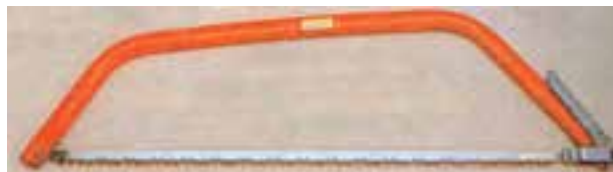
شکل ۲-۲۳ - اره کمانی با تیغه پهن و با دندانه گروهی مثلث متساوی‌الاضلاع
