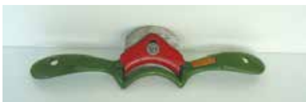
شکل ۳-۳۰ نحوه رندیدن قوسها بوسیله رنده بال کبوتری
