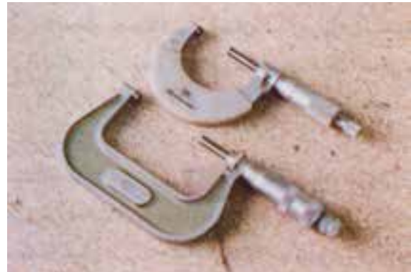
شکل ۱-۱۶- میکرومتر و قسمت‌های مختلف آن
