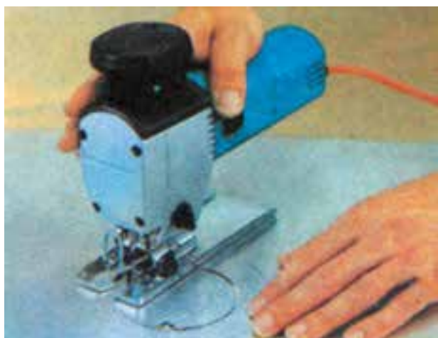
شکل ۲-۳۰ - اره عمودبر برقی در حال قوس‌بری
