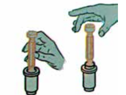
سر خوب وارد سوراخ می‌شود. سر خارج از اندازه فقط لبه اش گیر می‌کند.
