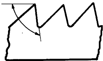
شکل ۹-۲- زاویه برش بیشتر از ۹۰ درجه
