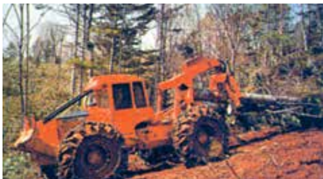
شکل ۱۷-۱- گرده‌بینه‌ها به وسیله تراکتورهای چوب‌کش از جنگل خارج می‌شوند (چرخ‌ها برای جلوگیری از سُرخوردن به زنجیر مجهز می‌شوند).
