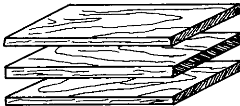
شکل ۵۵-۱- تخته چند لایه مطبق
