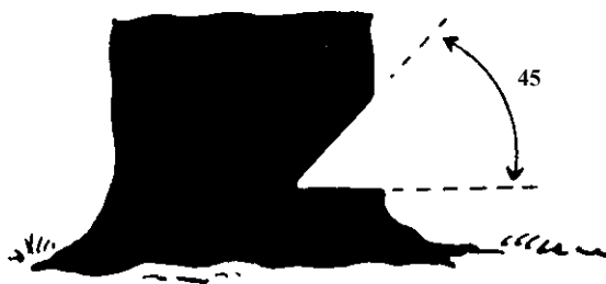
شکل ۱۱-۱- برای قطع درخت ابتدا عمل زیر برش مطابق شکل انجام می‌شود.
