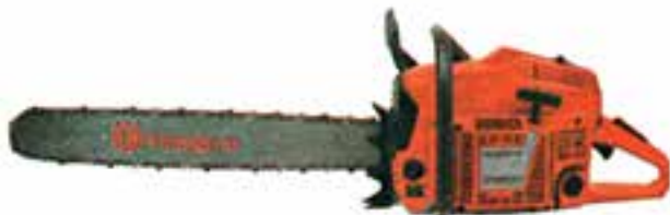
شکل ۱۰-۱- اره موتوری (بنزینی) جهت قطع درخت
