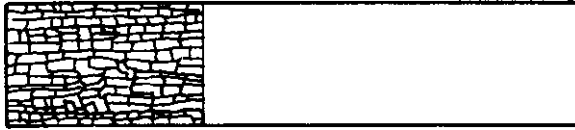
شکل ۴۰-۱- تخته خرده چوب تدریجی
