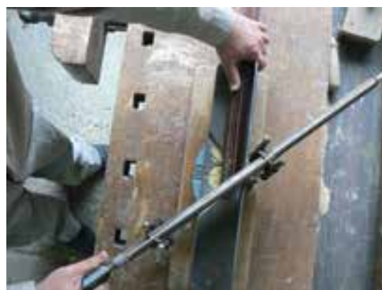
شکل ۲-۲۱- دستگاه فارسی بُر همراه با اره‌ی نوع فلزی
