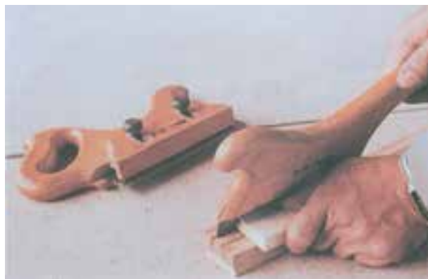
شکل ۲-۱۷- برش اتصال به وسیله‌ی اره طرح فرنگ
