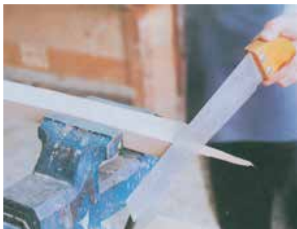
شکل ۸-۲- لاشه شدن انتهای چوب
