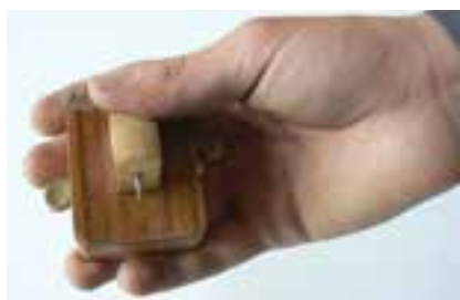
شکل ۱۲-۱- نحوه‌ی در دست‌گیری خطکش تیره‌دار
