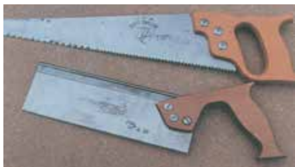
شکل ۲-۵-اره با دندانه رو به جلو
