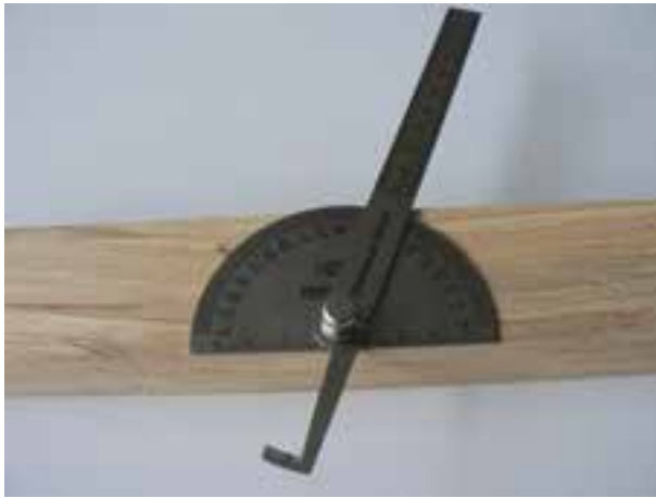
شکل ۱-۱۵- اندازه‌گیری و خط‌کشی زاویه به وسیله‌ی نقاله
