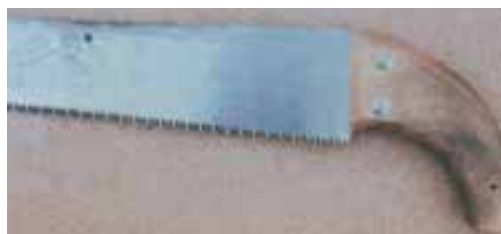
شکل ۲-۴- اره با دندانه رو به عقب
