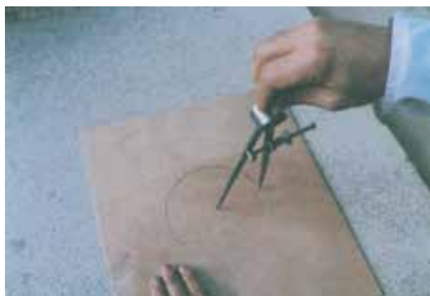
شکل ۱-۲۹- ترسیم دایره به وسیله‌ی پرگار معمولی
