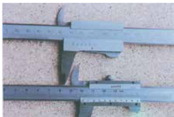
شکل ۱-۳۸ دو نمونه از ورنیه کولیس
