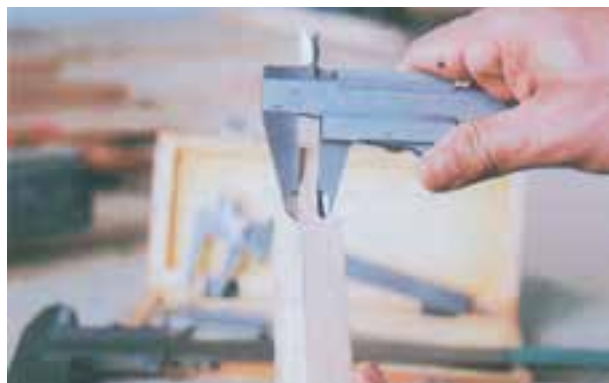
شکل ۱-۳۶- اندازه‌گیری اندازه‌ی خارجی قطعات به وسیله‌ی کولیس
