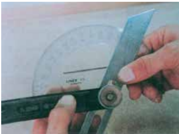
شکل ۱-۱۶- تنظیم گونیای تاشو به وسیله‌ی نقاله
