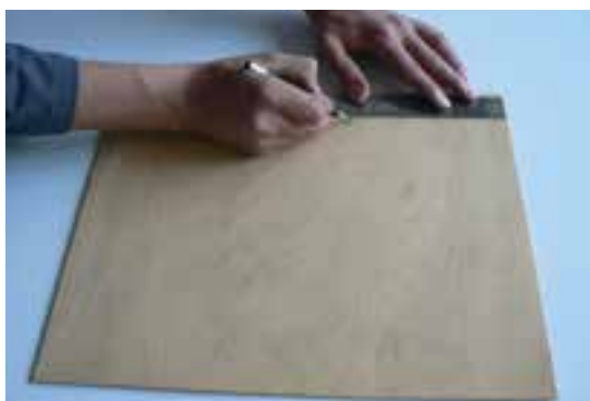
شکل ۱-۱- نحوه‌ی اندازه‌گذاری با خط‌کش فلزی
