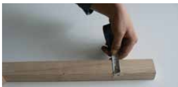
شکل ۱-۶- اندازه‌گیری در خارج کار
