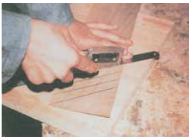
شکل ۲-۱۹- برش روکش با اره‌ی روکش‌بر
