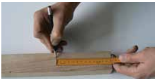
شکل ۱-۴- نحوه‌ی کاربرد متر تاشو
