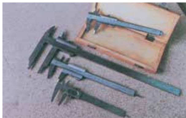
شکل ۱-۳۴- چند نوع کولیس
