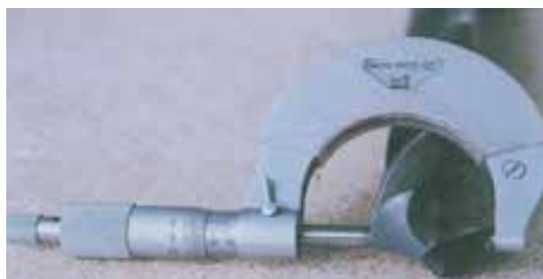
شکل ۱-۴۶- اندازه‌گیری به وسیله میکرومتر
