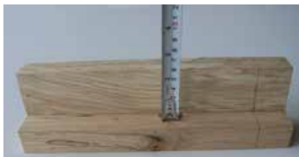
شکل ۱-۵- نحوه‌ی اندازه‌گیری برای داخل کار
