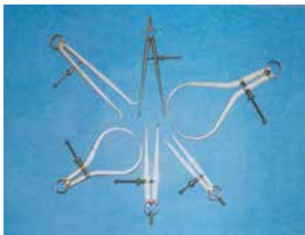
شکل ۱-۲۷- انواع پرگارهای اندازه‌گیر ساده، داخلی و خارجی
