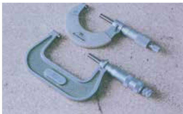
شکل ۱-۴۵- دو نمونه از میکرومتر
