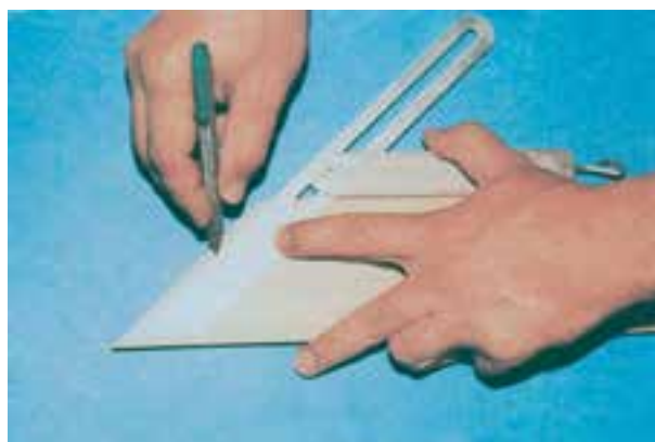
شکل ۱۸-۱- انتقال زاویه بر روی قطعه مورد نظر
