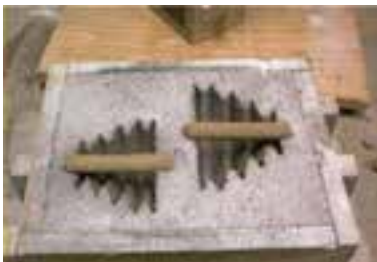
شکل ۵-۸- ماهیچه گذاری در قالب ریخته‌گری
