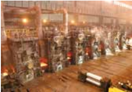
شکل ۸-۲۲- خط نورد گرم در کارخانه فولاد مبارکه اصفهان
