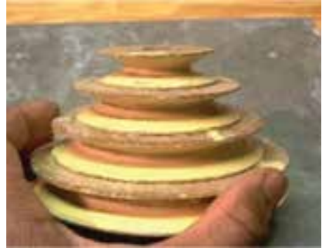
شکل ۲-۸- تهیه مدل ریخته‌گری ماسه‌ای
