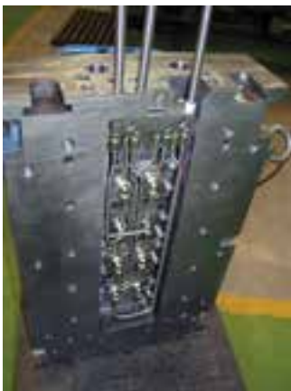
شکل ۸-۸- قالب فلزی ریخته‌گری (قالب تولید سر سیلندر در کارخانه ایران خودرو)
