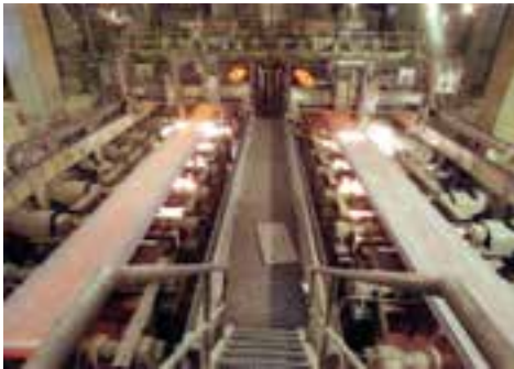
شکل ۸-۱۲- برش حرارتی نیم ساخته‌های ریخته‌گری شده در حالت گداخته در فرآیند ریخته‌گری پیوسته
