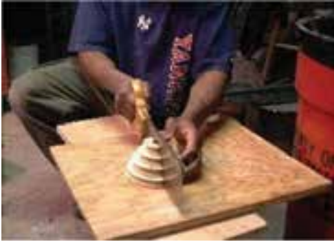
شکل ۲-۸- تهیه مدل ریخته‌گری ماسه‌ای
