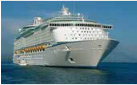
شکل ۹-۲- کشتی مسافربری ساخته شده از آلیاژهای آلومینیومی
