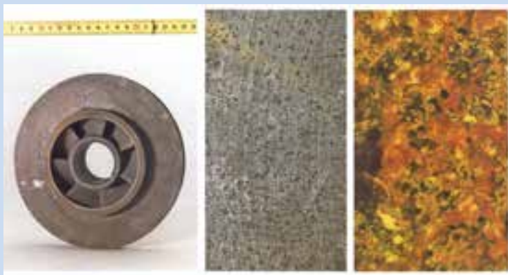
شکل ۱۹-۷- گرافیتی شدن پره پمپ از جنس چدن که دچار خوردگی انتخابی شده است.
