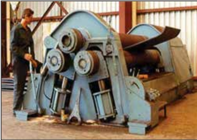
شکل ۷-۲۱- سطح غلتک‌های دستگاه نورد به دلیل نیروی مکانیکی دچار سایش می‌شود.
