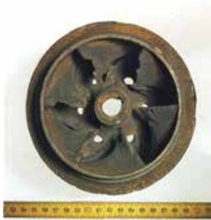
شکل ۲۳-۷- پره پمپ به دلیل قرار گرفتن در محلول خورنده حاوی ذرات ماسه دچار خوردگی فرسایشی شده است.
