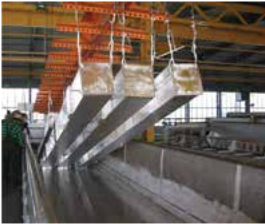
شکل ۸-۶. خط گالوانیزه کردن ورق و قوطی‌های فولادی
