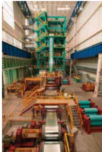
شکل ۸-۶. خط گالوانیزه کردن ورق و قوطی‌های فولادی
