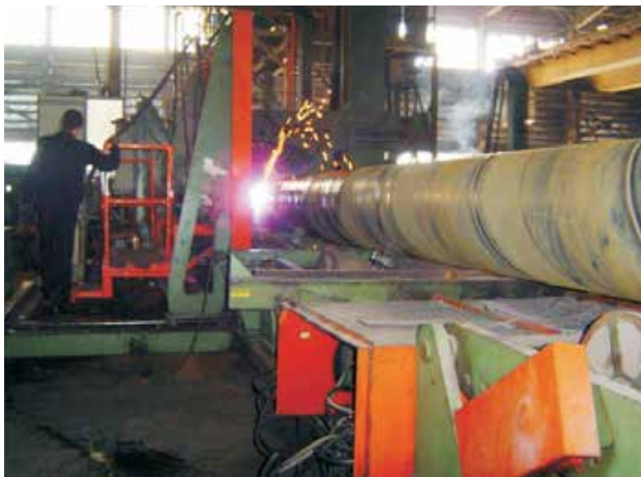
شکل ۲۷-۴ برشکاری لوله
