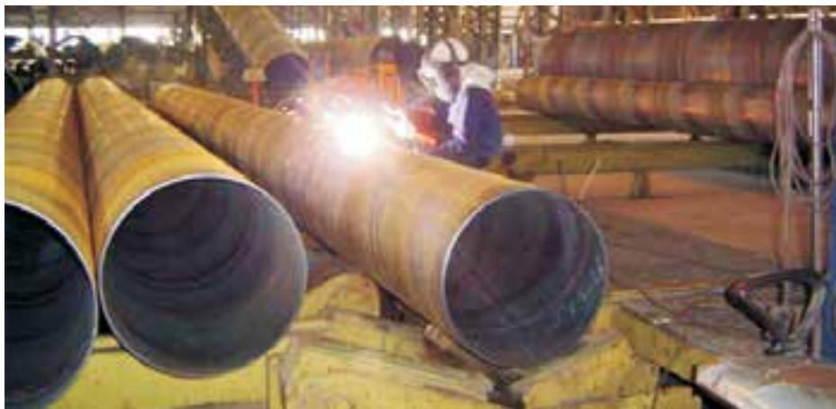
شکل ۴-۳۱ تعمیر لوله های معیوب
