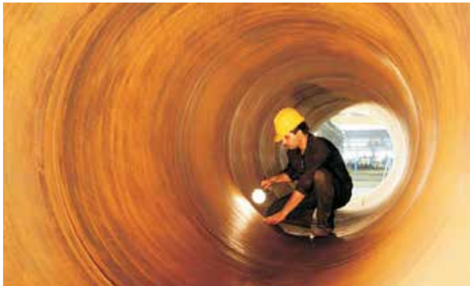
شکل ۴-۲۹ بازرسی چشمی لوله ها
