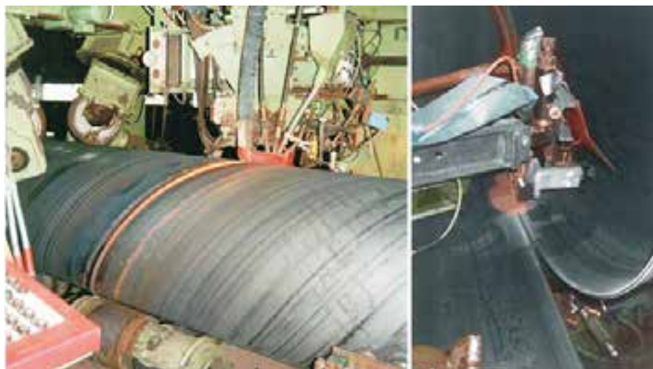
شکل ۴-۲۵- ب جوشکاری خارج لوله
