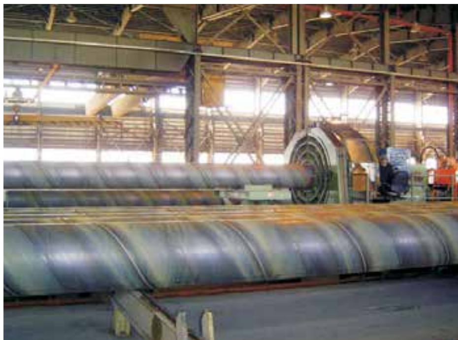
شکل ۴-۳۳ پخ کردن دو انتهای لوله
