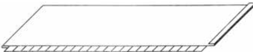
شکل ۱۹-۶ لبه‌های خمکاری شده جهت اتصال فرنگی پیچ
