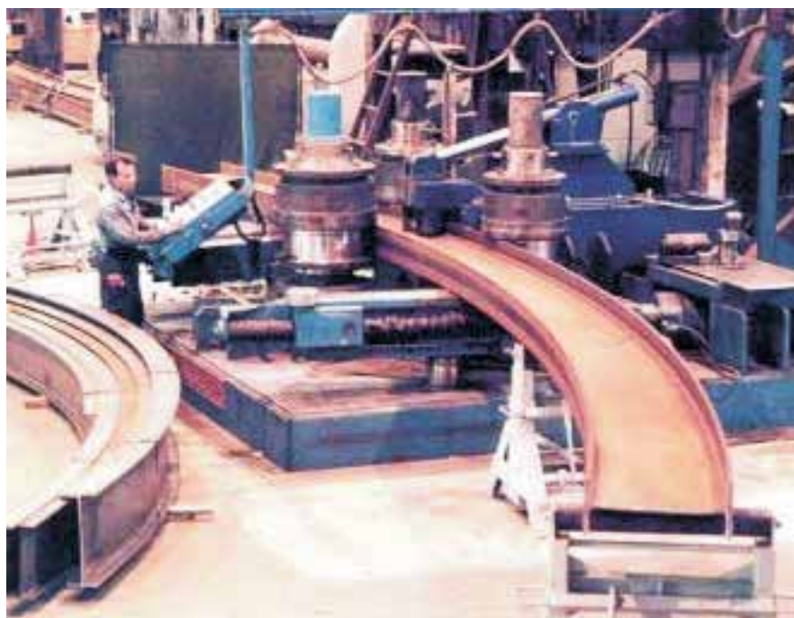
شکل ۵-۱۳ خمکاری دستی پروفیل‌ها
