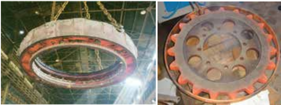
شکل ۳-۴- عملیات حرارتی سخت‌کاری سطح چرخ‌دنده بزرگ فولادی
