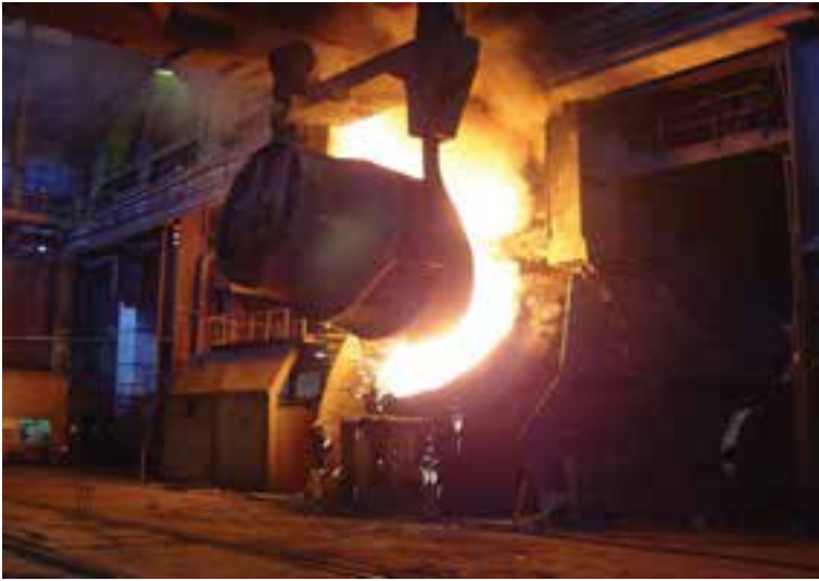
شکل ۵-۶- افزودن عناصر آلیاژی به مذاب فولاد در کارخانه فولادسازی
