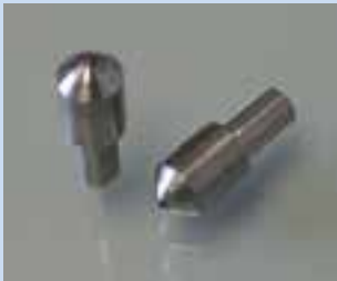
شکل ۲۱-۳- نمونه‌ای ابزار فرورونده جهت اندازه‌گیری سختی
