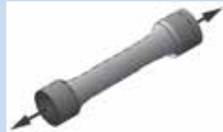
شکل ۱۶-۳- نمونه تست کشش طبق استاندارد ASTM A۳۷۰
