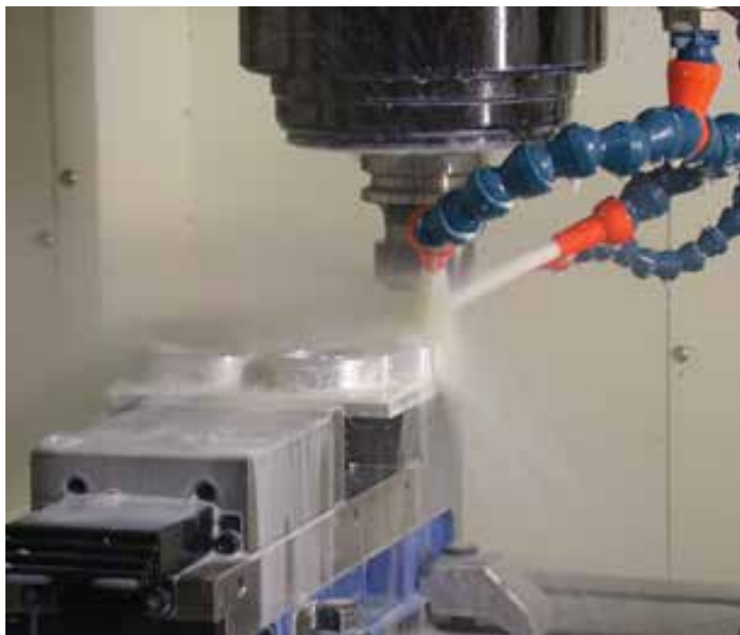
شکل ۳-۱۵ عملیات ماشین کاری قطعه فولادی
