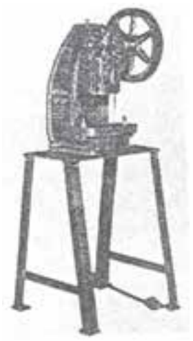
شکل ۲-۱۰ پرس ثابت رومیزی
