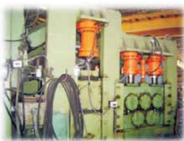
شکل ۴-۱۹ واحد صافکاری ورق‌ها
