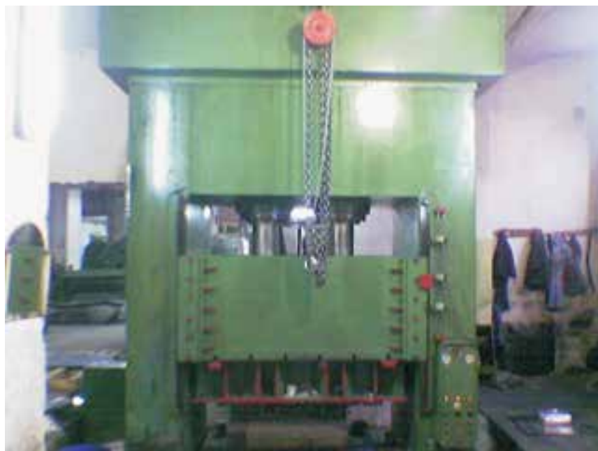
شکل ۲-۱۵ پرس راست جانب صلب
