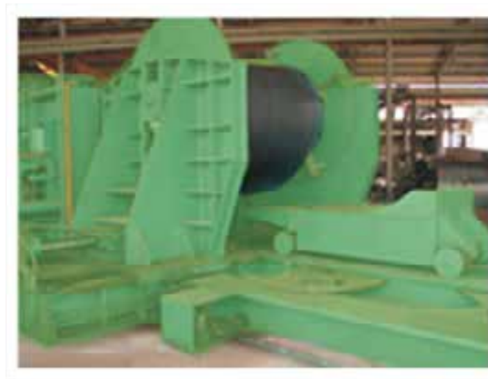
شکل ۴-۱۸ واحد باز کردن ورق ها
