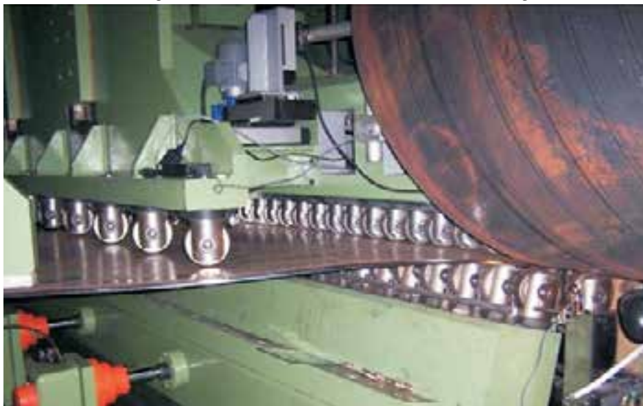
شکل ۴-۲۳-ج شکل‌دهی لوله‌ها
