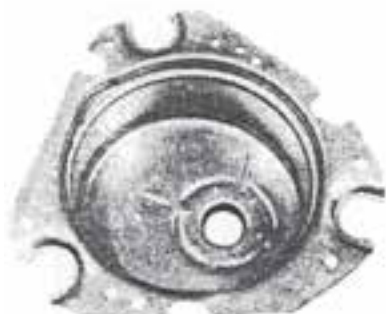
شکل ۲-۳۸ ایجاد برجستگی برای جوشکاری
