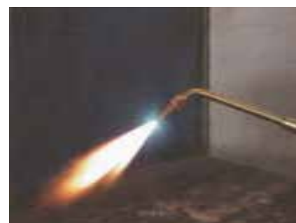
شکل ۴-۲ شعله ی سوختن گاز استیلن با اکسیژن
