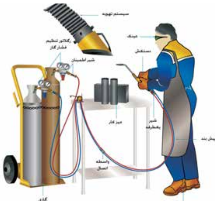
شکل ۲-۱۳ تجهیزات جوشکاری در یک کابین جوشکاری
