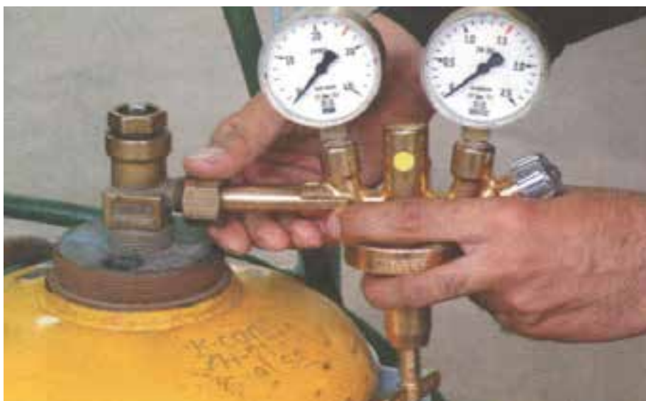
شکل ۲۲-۱-۲ بستن رگولاتور به کپسول
