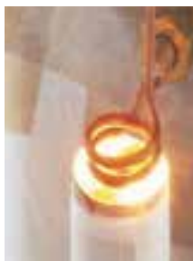
شکل ۷-۴ گرم کردن به روش القایی
