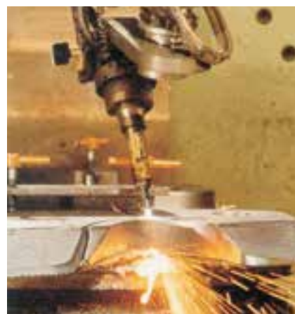
شکل ۱۵-۵ برشکاری پلاسما
