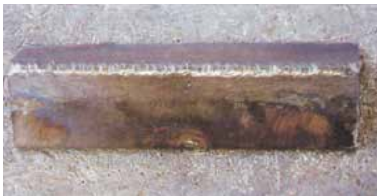
شکل ۸-۳۲ کار ذوب گوشه تمام شده
