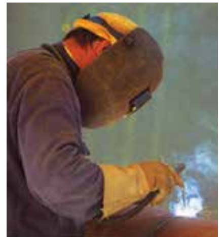
شکل ۱-۱ جوشکاری با الکتروود روپوش دار
