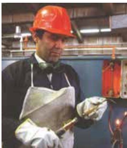
شکل ۸-۱۲ بستن سر مشعل به مشعل
