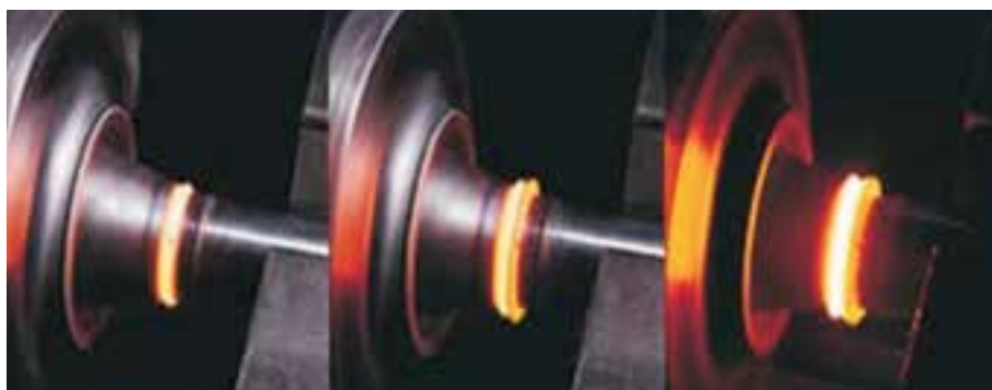
شکل ۵-۷ جوشکاری اصطکاکی
