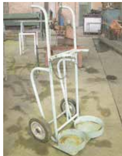
شکل ۸-۱ ارابه مخصوص کپسول دستگاه جوشکاری گاز
