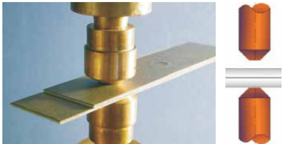
شکل ۷-۱ نحوه نقطه جوش
