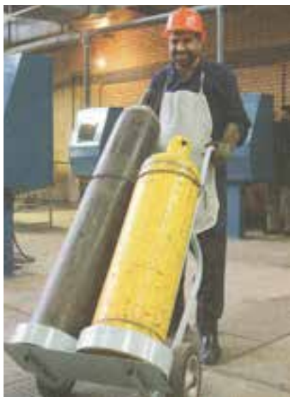
شکل ۸-۲ نحوه بستن و حمل کپسول‌ها
