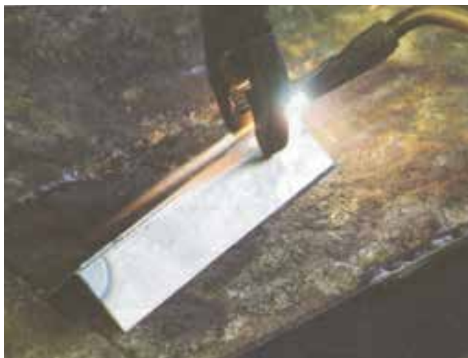
شکل ۸-۳۰ روش خال جوش زدن
