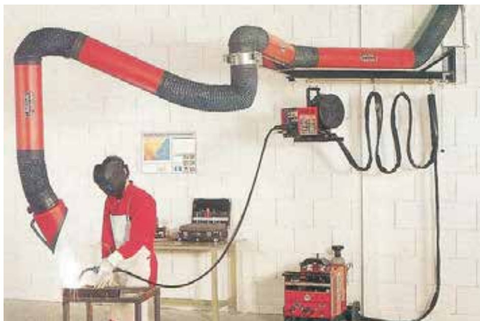
شکل ۵-۳ خروج گاز از محل جوشکاری و تصفیه و هدایت به هوای بیرون
