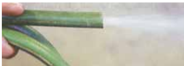
شکل ۱۴-۳ خروج پودر تالک از شیلنگ نو
