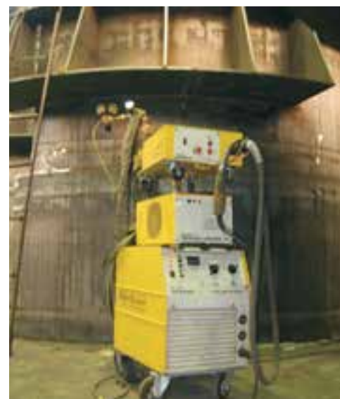
شکل ۱-۱۱-۱ دستگاه جوشکاری MIG/MAG
