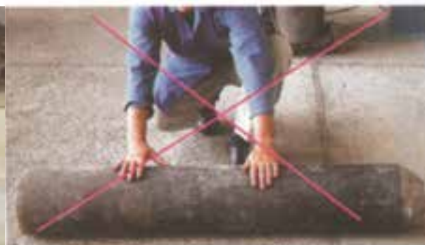
شکل ۳-۱۰-۲ روش غلط جابه‌جایی کپسول
