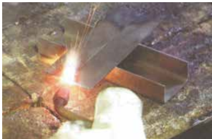
شکل ۴۸-۱ خال جوش زدن در طرفین اتصال
