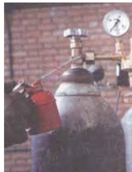
شکل ۳-۱۰ کار اشتباه روغن‌کاری کپسول اکسیژن
