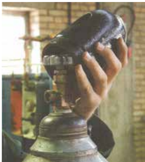
شکل ۸-۳ کلاهک روی شیر فلکه کپسول
