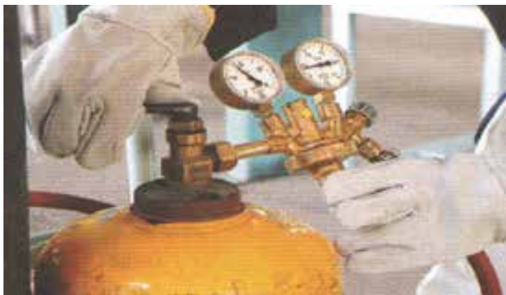
شکل ۱۰-۸ نحوه باز کردن شیر فلکه کپسول استیلن
