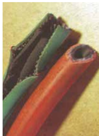
شکل ۲-۲۳ لایه‌های شیلنگ‌های گاز
