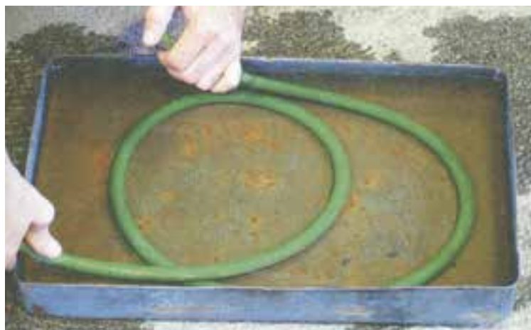
شکل ۸-۸-۱ کنترل سلامت شیلنگ‌ها
