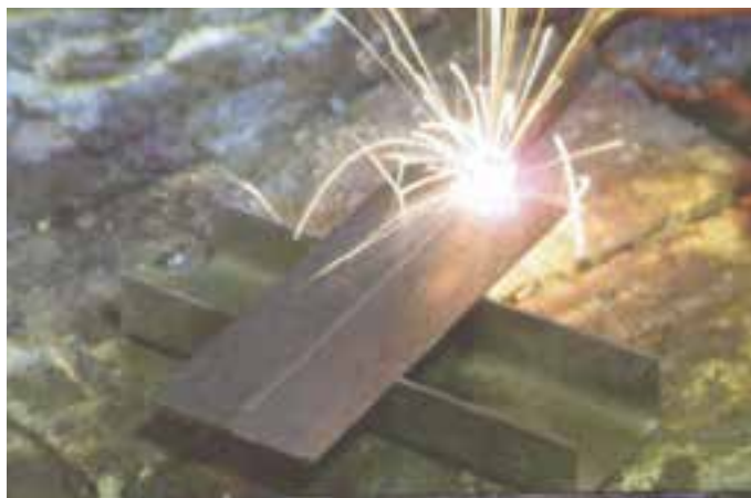
شکل ۴۸-۸ خال جوش زدن در طرفین اتصال
