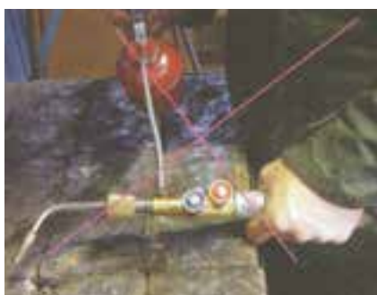
شکل ۳-۱۷ کار اشتباه روغن کاری مشعل
