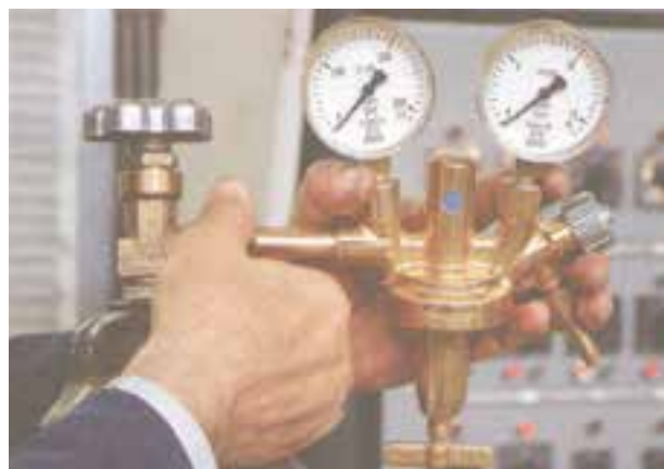
شکل ۴-۸ نحوه بستن رگولاتور کپسول اکسیژن
