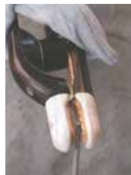
شکل ۵-۱ انبر الکتروودگیر
