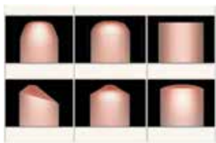
شکل ۷-۱۳ فرم سطح مقطع الکتروودهای نقطه جوش
