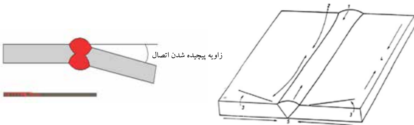
شکل ۴-۱۴ پیچیدگی در جوش
