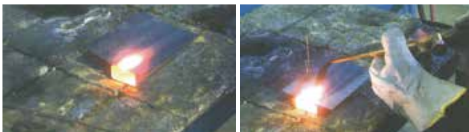
شکل ۲۵-۸ چگونگی ایجاد ذوب سطحی
