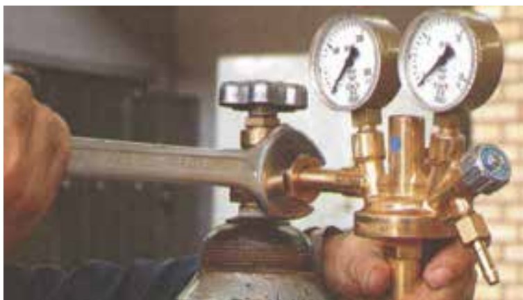
شکل ۵-۸ نحوه بستن رگولاتور کپسول اکسیژن
