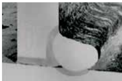
شکل ۴-۹ سرفتگی جوش ماهیچه ای
