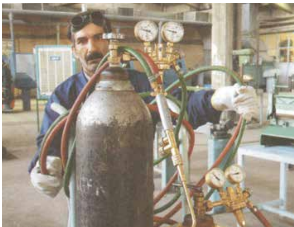
شکل ۸-۲۷ جمع کردن شیلنگ ها
