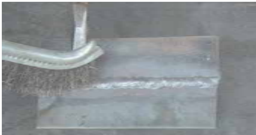
شکل ۴۴-۸ روش بُرس زدن روی خط جوش
