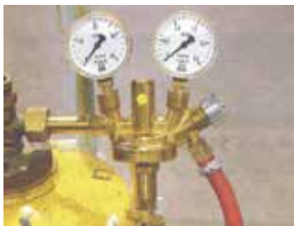
شکل ۸-۱۱ تنظیم فشار گاز استیلن
