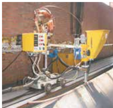
شکل ۱-۸ جوشکاری زیرپودری با واگن متحرک
