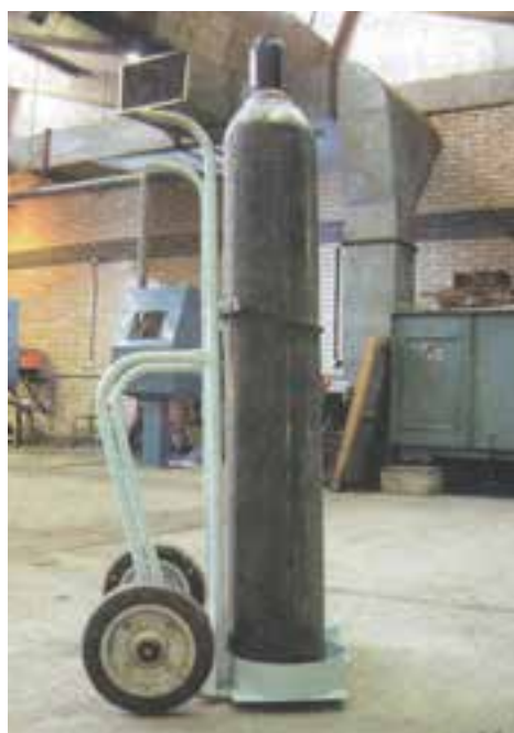
شکل ۱۵-۲ کپسول‌ها بالت وزنجیر
