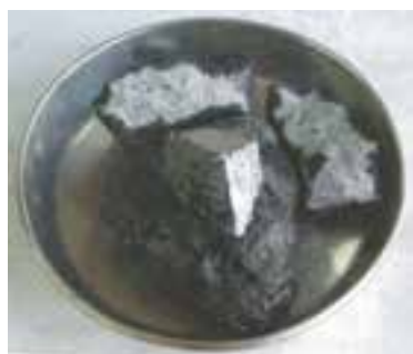
شکل ۸-۲ مقطع شکسته شده‌ی سنگ کاربید و شکل ظاهری آن
