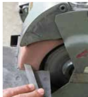
شکل ۴-۹ تیز کردن زاویه آزاد پیشانی
