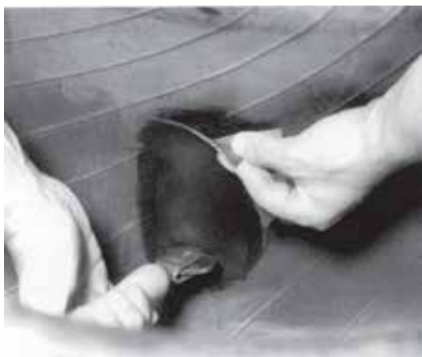
شکل ۶-۶-۷ پرکردن حفره با وصله‌های لاستیکی متعدد لایه لایه
