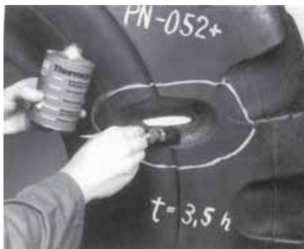
شکل ۶-۶-۶ چسب زدن محدودی حفره‌ی ترکیدگی
