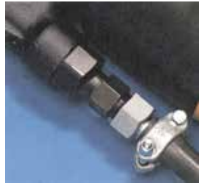
ه- کوپلینگ پیچی و شیلنگ با یک بست اتصال
