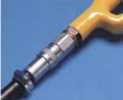
د- نوعی کوپلینگ که با سرعت، باز و بسته می‌شود.
