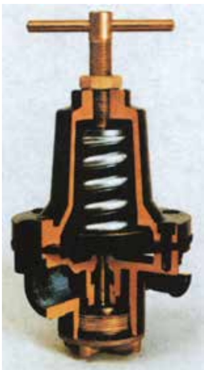
شکل ۱۷-۷- قسمت‌های داخلی یک شیر فشار شکن
