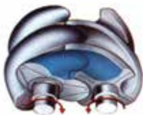
شکل ۱۰-۶- اصول کار کمپرسور پیچی
