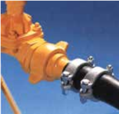
و- کوپلینگ ساده‌ی شیلنگ با دو بست
