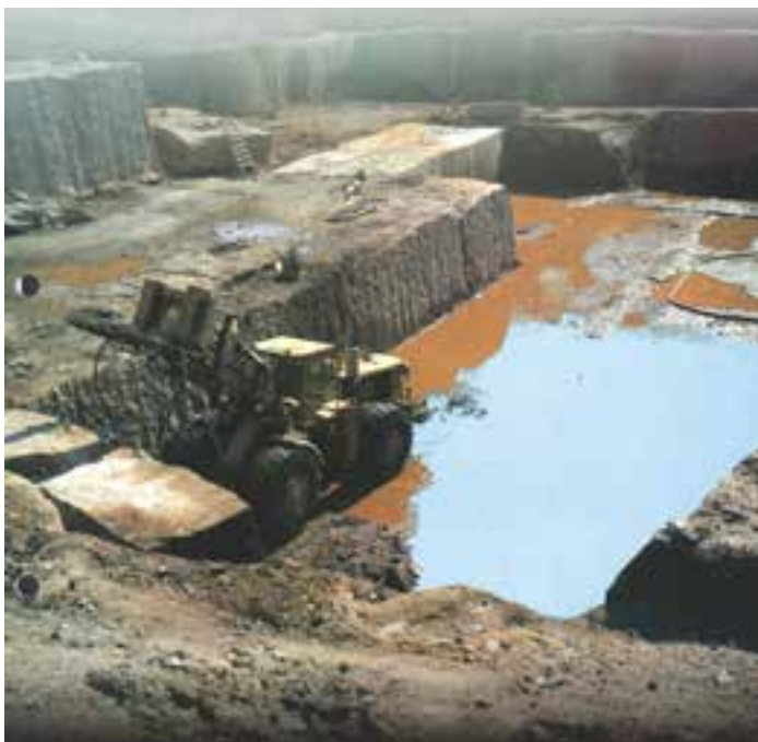
شکل ۲۶-۵- تجمع آب در معدن روباز
