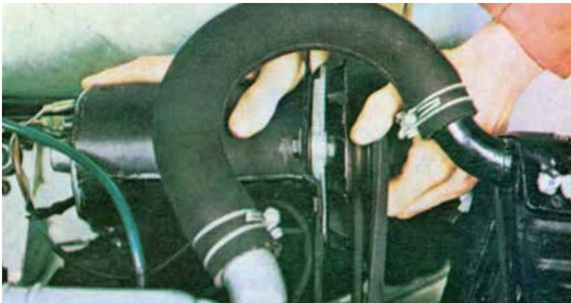
ب) خارج کردن تسمه پروانه از پولی دینام
