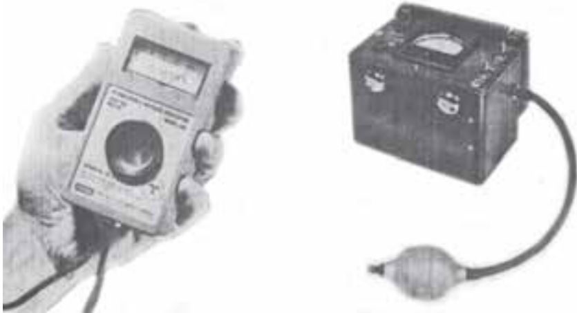
شکل ۱-۲- دستگاه‌های اندازه‌گیری عقربه‌ای مقدار اکسیژن شکل سمت راست با سیستم مکنده به صورت دستی تلمبه‌ای و شکل سمت چپ با سیستم مکنده توسط موتور کوچک الکتریکی
