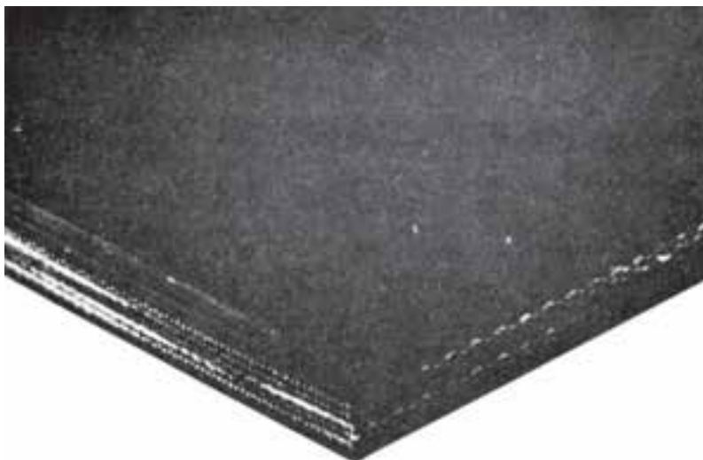
شکل ۱-۳۵- ساختمان نوار باربری دستگاه نوار نقاله
