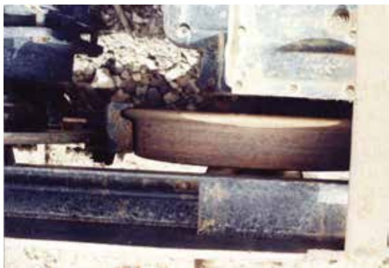
شکل ۳-۳۲- نحوه‌ی عملکرد کفشک‌های ترمز بر روی چرخ
