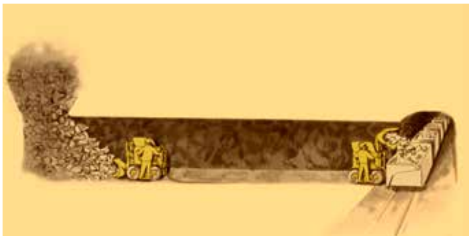
شکل ۶-۳- مراحل کارکرد لودر تونلی (خاک بر سر)
