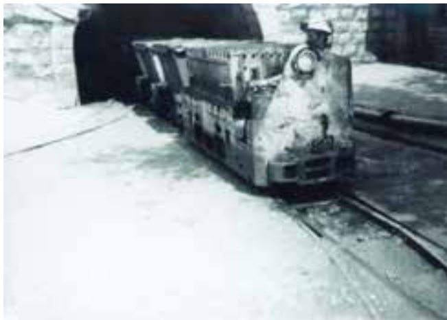
شکل ۱۴-۳۲- چراغ یک لوکوموتیو معدنی
