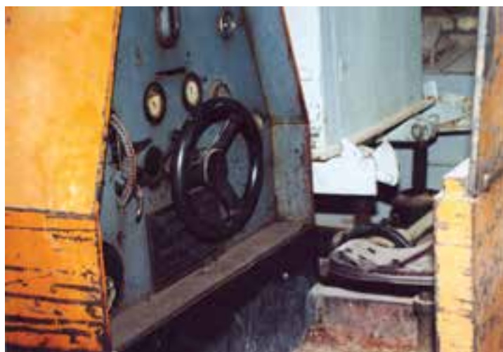
شکل ۲-۳۲- نحوه‌ی عملکرد ترمز لوکوموتیو
