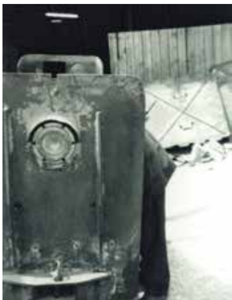
شکل ۱۴-۳۲- چراغ یک لوکوموتیو معدنی
