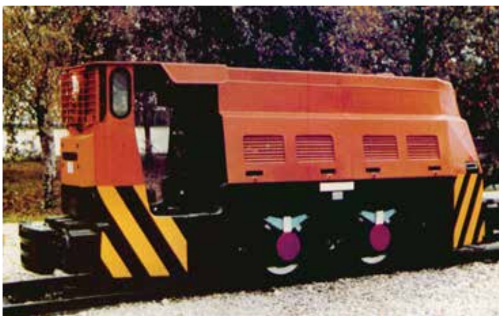
شکل ۸-۳۲- سپر ثابت فولادی و فنردار یا لاستیکی
