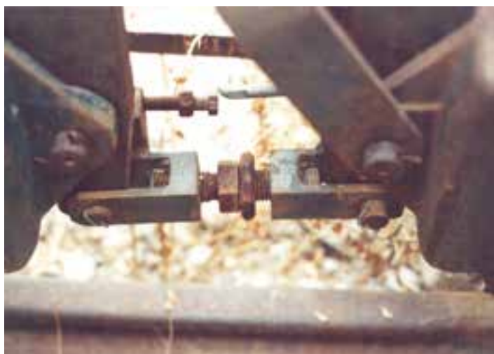
شکل ۲-۳۲- نحوه‌ی عملکرد ترمز لوکوموتیو
