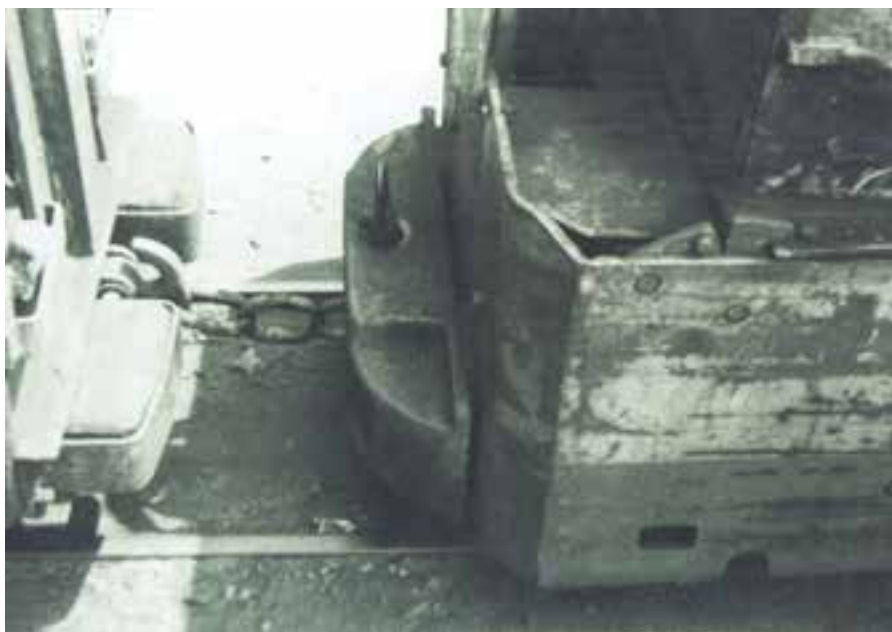
شکل ۱۶-۳۲- زنجیر و قلاب اتصال لوکوموتیو و واگن
