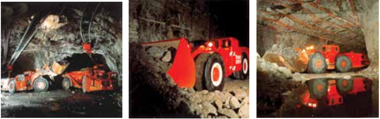
شکل ۴-۳۰- انواع لودر معدنی زیرزمینی و نحوه کارکرد آن‌ها
