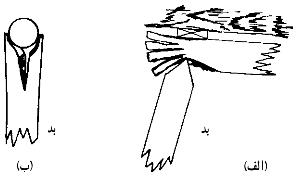
الف - باریک کردن بیش از حد ستون ب - نامساوی بودن شمع کلاهدک با شمع قوسی ستون
