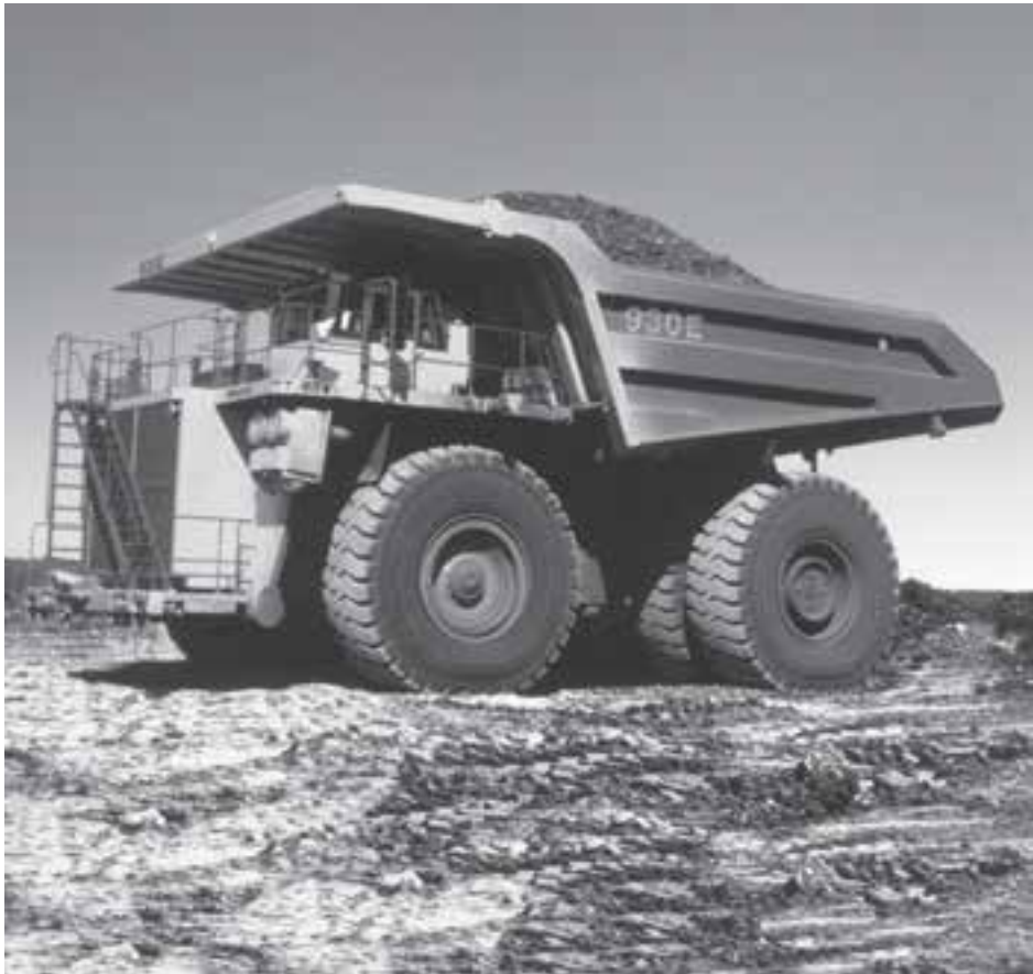
شکل ۱۳-۲۴- نمونه ای از کامیونهای حمل و نقل مواد معدنی در بیرون معدن و معادن روباز
