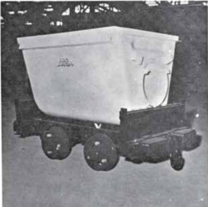
شکل ۱۲-۱۹- نمای ظاهری و مشخصات یک واگن معدنی ساخت کارخانه ماشین سازی اراک
